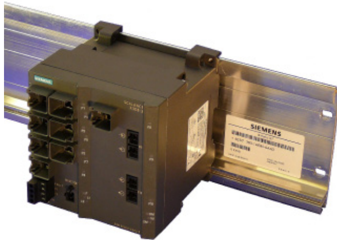
Figure 5-3 Montage d'un switch IE X-300 sur profilé support S7-300 SIMATIC
