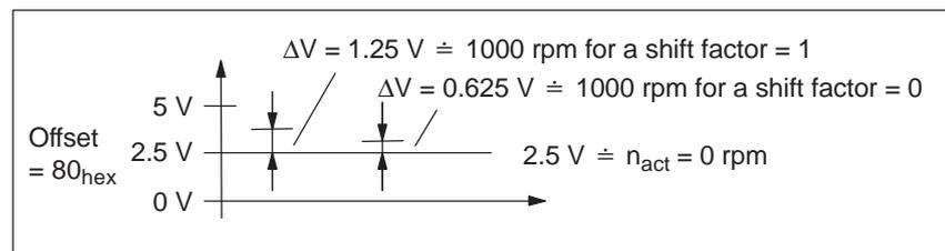
Fig. 6-2 Voltage values when measuring the speed actual value
