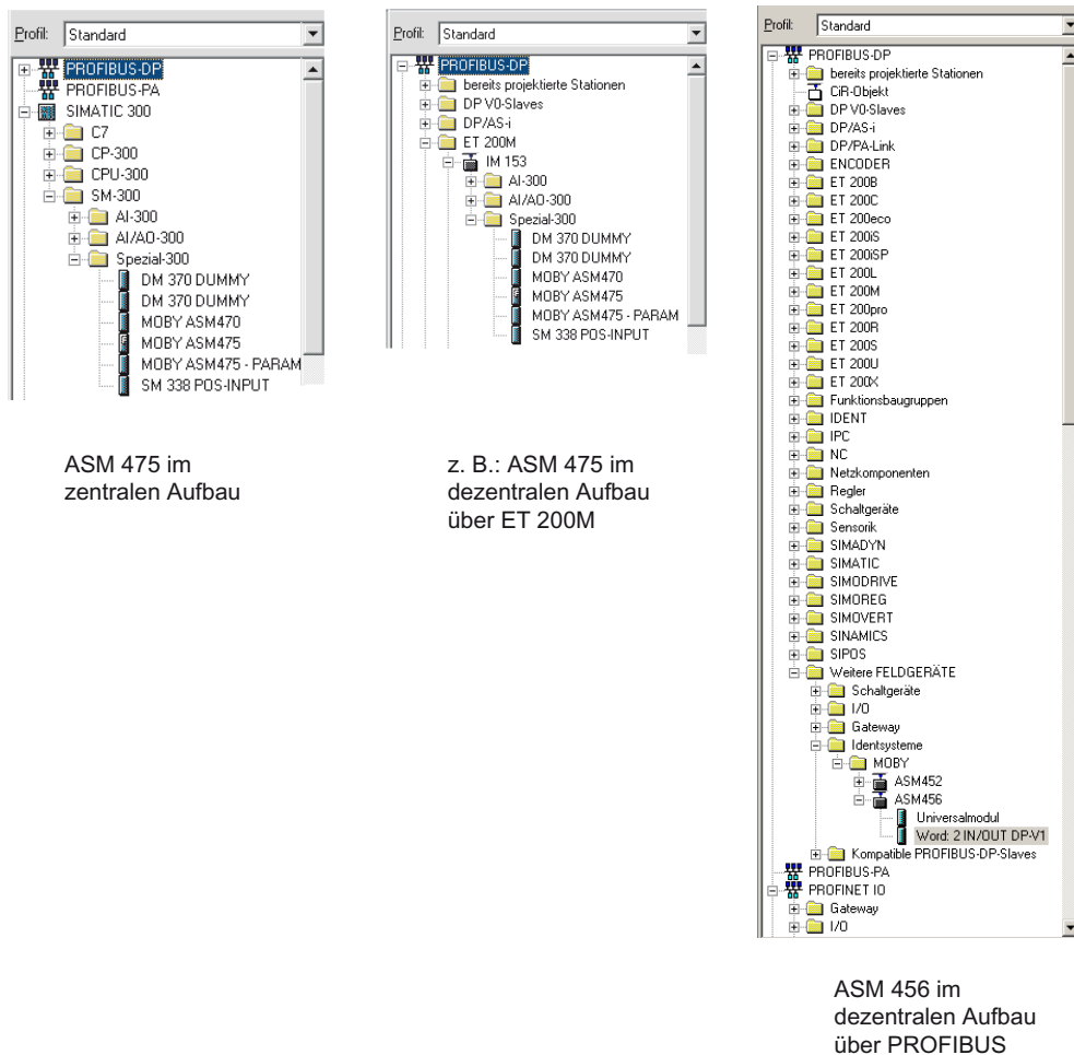
Bild 4-1 Lokalisierung der Kommunikationsmodule im Hardwarekatalog
