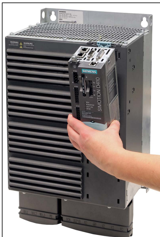
Aufschnappen der SIMOTION D410 auf das Power Module PM340
