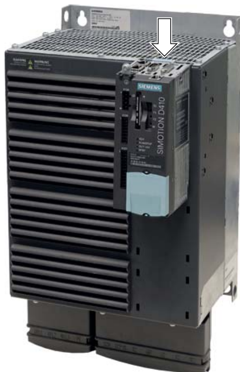
Bild 4-1 Entfernen der SIMOTION D410 vom Power Module PM340
