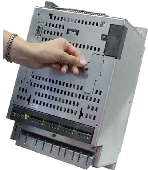
3. Entfernen Sie die Lüfterabdeckung.
