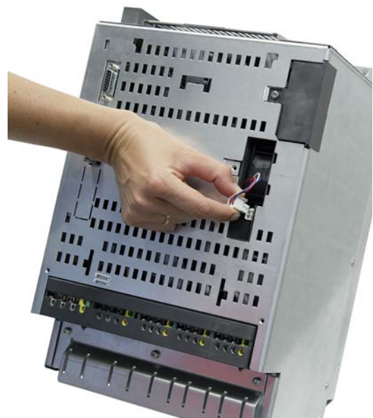
4. Ziehen Sie den Anschluss-Stecker ab. Drücken Sie dazu die Verriegelung und den Stecker leicht zusammen.
