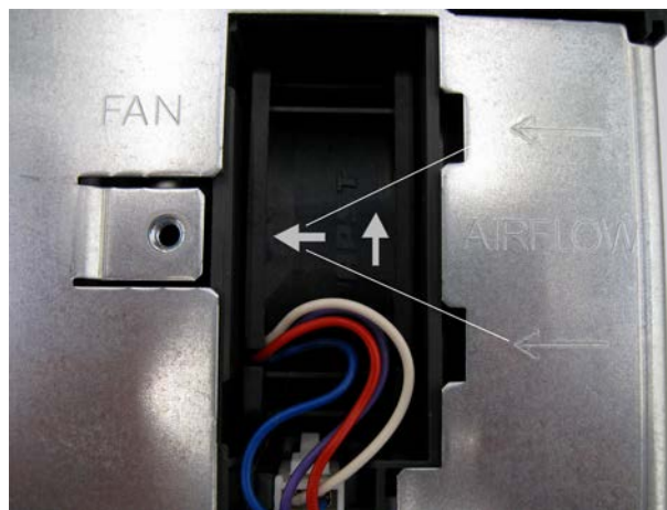
Bild 13-1 Pfeile auf dem Lüfter für die Durchströmungsrichtung
