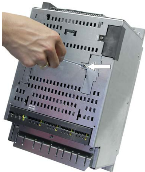
2. Entfernen Sie die Torx-Schlitz-Schraube der Lüfterabdeckung.
