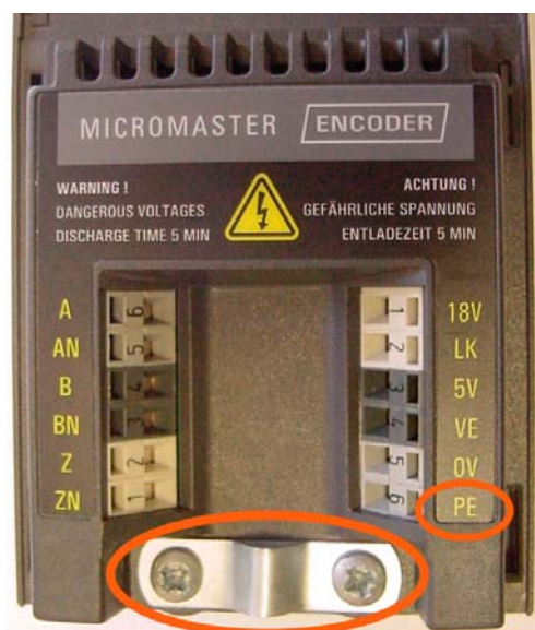
图 6-4 屏蔽接线端和 PE 端子
