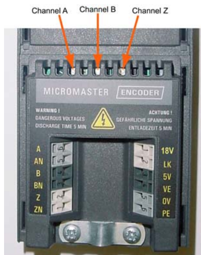
图 6-5 编码器模板上的 LED 指示灯
