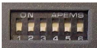
图 6-6 编码器模板的 DIP 开关
