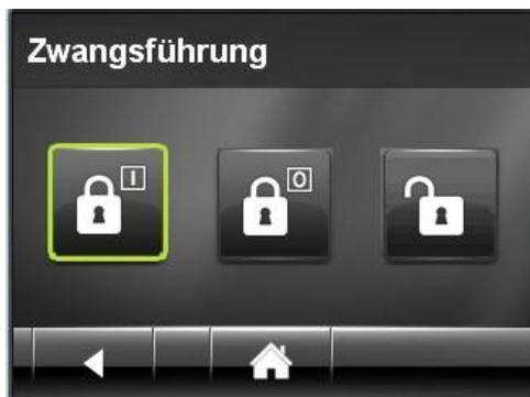
Abb. 15. Beispiel für Zwangsführung (hier: Zwangsführung aktivieren und Schaltzustand EIN)
