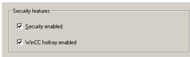
Manche Programme, z. B. WinCC (TIA-Portal), interpretieren die über die Tastaturschnittstelle gesendete Reihenfolge der Tastencodes in eigener Weise. Die Funktion "WinCC hotkey" ermöglicht eine Anpassung an dieses Verhalten.
