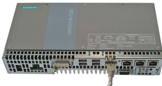
Bild 5-5 LAN-Kabel an Onboard-Ethernet-Schnittstelle angeschlossen
