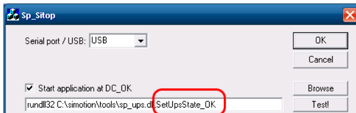
Bild 7-25 Beispiel Kommando bei Zustandswechsel auf DC_OK
