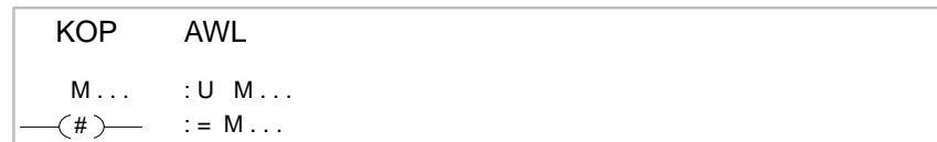
Bild A-7 Konnektor in KOP und AWL
