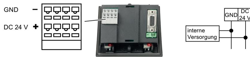
Bild 5-12 Klemmenblock der Ausführung mit M12 Buchsen auf Schaltschrankseite (IP20)
