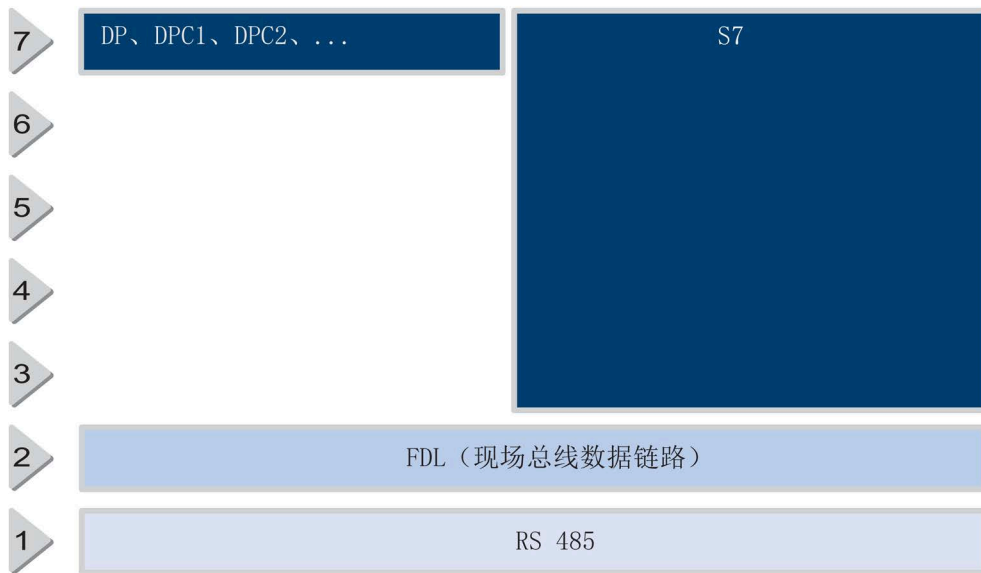
图 2-4 ISO/OSI 参考模型中的 PROFIBUS
