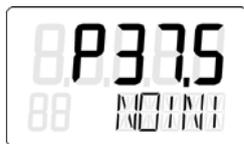
2. Vérifiez la bonne mobilité des pièces mécaniques dans toute la plage de réglage. Déplacez à cet effet le servomoteur à l'aide des touches  $\triangle$  ou  $\nabla$  jusqu'aux positions finales.
