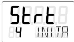
Pendant l'initialisation automatique, le positionneur passe par 5 étapes d'initialisation. Les indications concernant les étapes d'initialisation "RUN1" à "RUN5" s'affichent sur la ligne inférieure de l'écran. Le processus d'initialisation dépend du servomoteur utilisé et peut durer jusqu'à 15 minutes.
