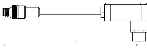
Bild 13-1 Anschlusskabel M12 → Reader / SLG; l = 2 m, 5 m (MOBY U)
