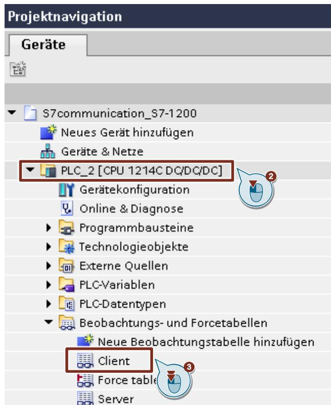
4. Klicken Sie in der Funktionsleiste auf die Schaltfläche "Alle beobachten". Die aktuellen Werte, die im Sendedatenbereich (DB1) und Empfangsdatenbereich (DB2) gespeichert sind, werden in der Spalte "Beobachtungswert" angezeigt.
