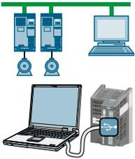
**STARTER** oder **Startdrive** sind PC-Tools zur Inbetriebnahme, Diagnose und Steuerung des Umrichters sowie zum Sichern und Übertragen der Umrichter-Einstellungen. Sie können den PC entweder über USB oder über den Feldbus PROFIBUS / PROFINET mit dem Umrichter verbinden.
