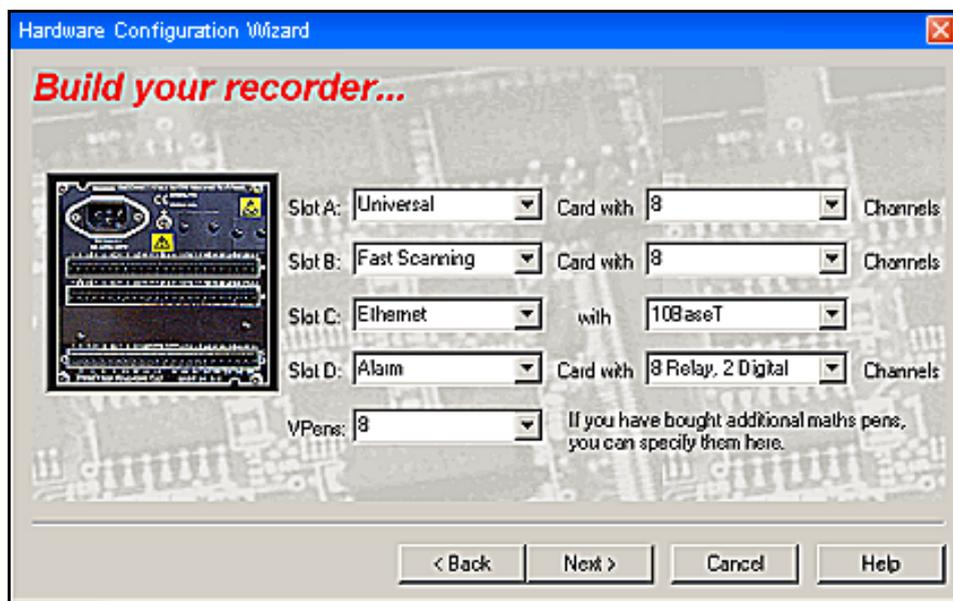
Les emplacements A et B sont destinés aux entrées analogiques ; sélectionnez les cartes universelles, à balayage rapide, linéaires ou de sortie selon les options équipant l'enregistreur. Si des cartes d'entrée analogiques sont sélectionnées, assurez-vous que le nombre correspondant de canaux est affiché dans la zone associée dans l'assistant de configuration du matériel.
