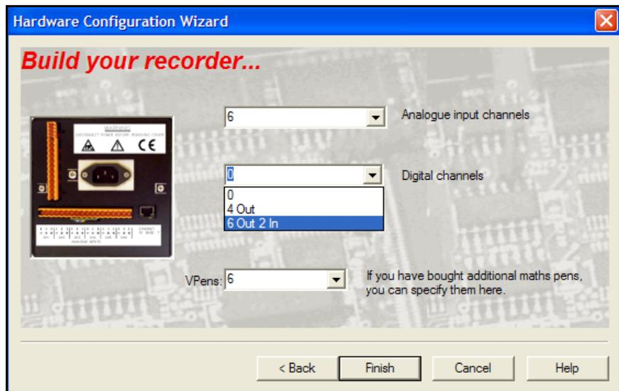
La configuration de l'enregistreur **SIREC DS** ne nécessite que le réglage du nombre de voies analogiques, soit 2, 4 ou 6 entrées. La boîte Voies logiques n'est disponible que si l'enregistreur est équipé d'une carte d'alarme. Les deux cartes d'alarme disponibles sont une carte 4 sorties relais ou une carte 6 sorties relais avec 2 entrées logiques. Sélectionnez le réglage approprié pour l'enregistreur et cliquez sur le bouton Terminer.
