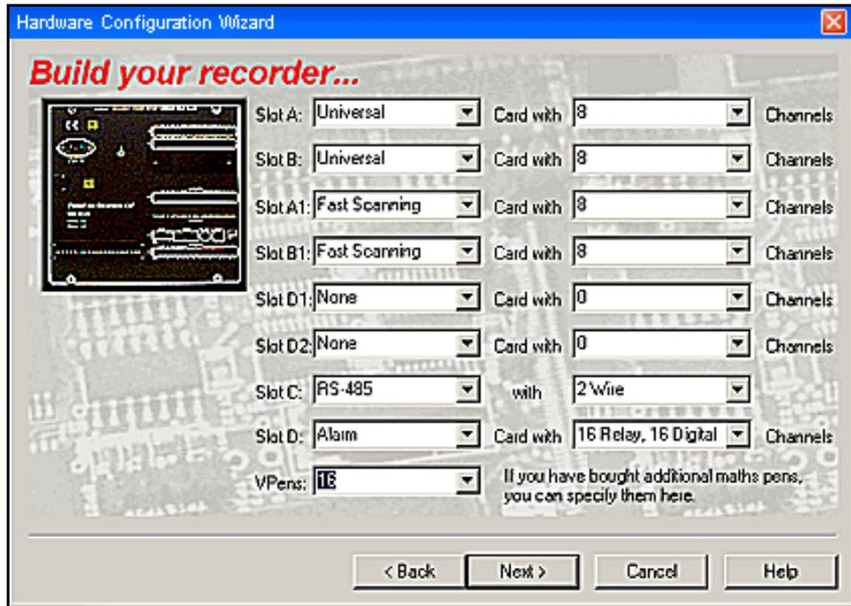
Les emplacements A et B, A1 et B1 sont destinés aux entrées analogiques ; sélectionnez les cartes universelles, à balayage rapide, linéaires ou de sortie selon les options équipant l'enregistreur. Si des cartes d'entrée analogiques sont sélectionnées, assurez-vous que le nombre correspondant de canaux est affiché dans la zone associée dans l'assistant de configuration du matériel.
