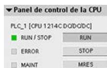
El "Panel de control de la CPU" muestra el estado operativo (STOP o RUN) de la CPU online. También indica si la CPU tiene un error o si se están forzando valores.
