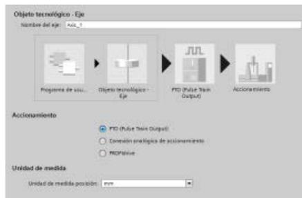
Después de crear el objeto tecnológico para el eje, se configura el eje definiendo los parámetros básicos, como el PTO y la configuración de la interfaz del accionamiento. También se configuran las demás propiedades del eje, como los límites de posición, las animaciones y la referenciación.
