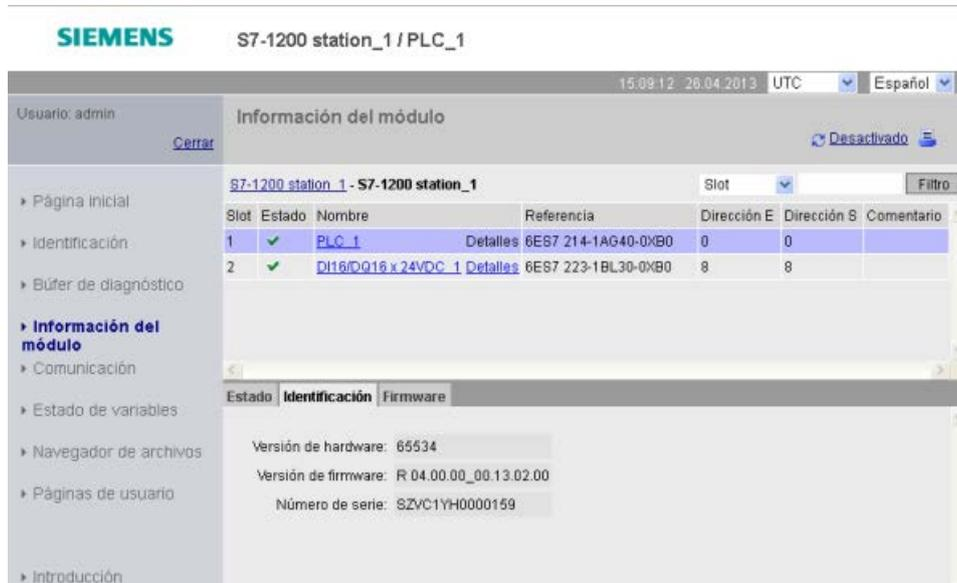
Tenga en cuenta que si se hace clic en la parte superior de un módulo F de E/S, la parte inferior tendrá una pestaña denominada Seguridad. En esta pestaña es posible especificar datos relacionados con el módulo seleccionado, tal como se describe en Manual de seguridad funcional S7-1200
