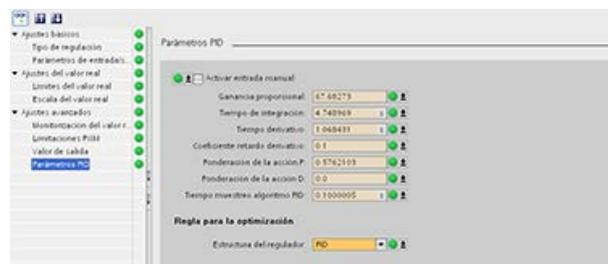
Ahora puede cambiar el valor de cualquier parámetro de configuración del regulador PID como muestra la figura inferior.
