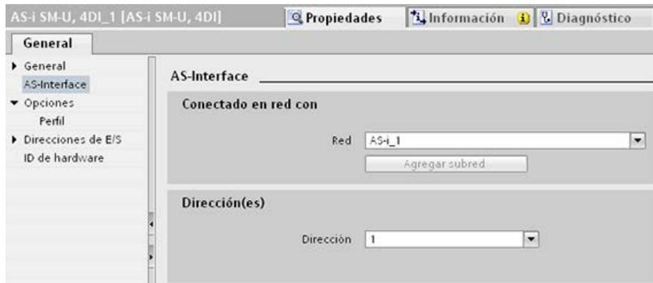
El módulo de entradas digitales (AS-i SM-U, 4DI) en la red AS-i anterior ha recibido la dirección de E/S 2. Al hacer clic en el módulo de entradas digitales, la ficha "Direcciones de E/S" de "Propiedades" muestra la dirección de E/S, como se muestra a continuación:
