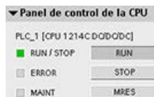
Utilice el botón del panel de operador para cambiar el estado operativo (STOP o RUN). El panel de operador también dispone de un botón MRES para resetear la memoria.
