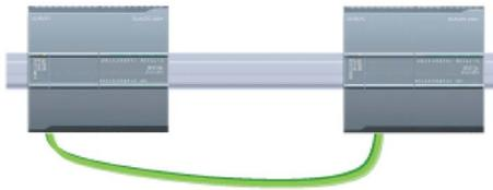
Una CPU conectada a otra CPU
