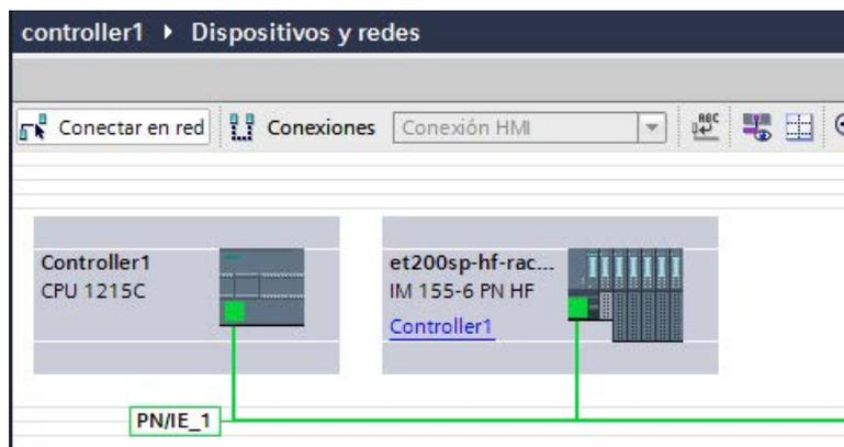
6. Haga doble clic en el dispositivo IO e inserte todos los módulos y submódulos necesarios del catálogo de hardware en la tabla de la vista general de dispositivos.
