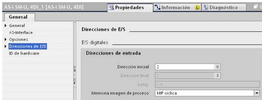
Para acceder a los datos de los esclavos AS-i en el programa de usuario, se utilizan las direcciones E/S con las operaciones de lógica binaria adecuadas (p. ej. "Y") o bien asignaciones de bits. El siguiente programa sencillo muestra cómo funciona la asignación:
