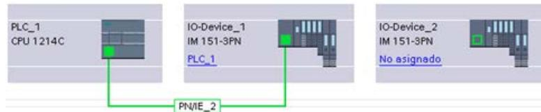
Cuando se descargan las nuevas conexiones de red, la CPU debe estar en modo STOP.
