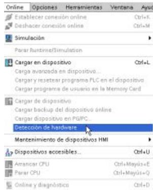
Si existe una conexión con una CPU, es posible cargar su configuración en el módulo (incluidos los módulos). Tan solo hay que crear un proyecto nuevo y seleccionar la "CPU sin especificar" en lugar de una específica. (También es posible omitir la configuración de dispositivo por completo seleccionando "Crear un programa PLC" en "Primeros pasos". Entonces, STEP 7 crea automáticamente una CPU sin especificar).
