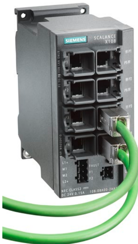
Bild 5-2 Stecken des IE FC RJ45 Plug 180
