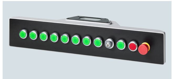
Equipamiento de una Extension Unit Advanced (ejemplo de KP48 de 22")
