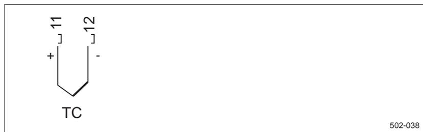
Bild 3.6-5 Thermoelement-Anschluß
