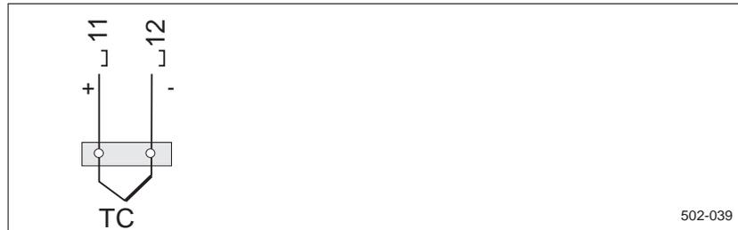
Bild 3.6-6 Thermoelement-Anschluß an externe Vergleichsstelle mit konstanter Temperatur
