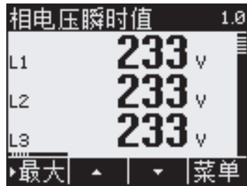
图 3-2 3P4W接线方式下的电压测量值画面
