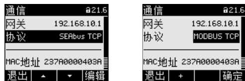
图 3-11 切换到 MODBUS TCP 协议
