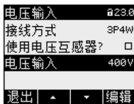
图 7-8 设备设置“电压输入”
