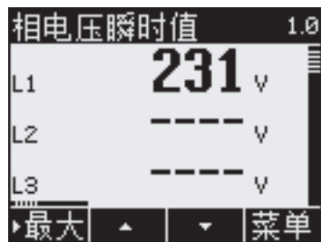
图 3-3 1P2W接线方式下的电压测量值画面
