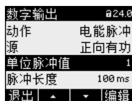
图 3-6 电能脉冲输出
