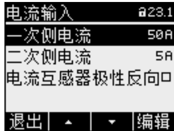
图 7-9 设备设置“电流输入”
