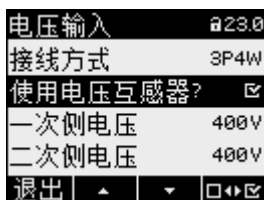
图 7-6 设备设置“使用电压互感器？”
