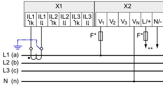
Bild 6-10 Anschlussart 3P4WB, ohne Spannungswandler, mit einem Stromwandler
