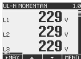
Bild 3-2 Anzeige der Messspannung bei Anschlussart 3P4W
