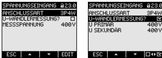
Bild 9-5 Geräteeinstellung "SPANNUNGSEINGANG"
