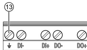
Bild 6-5 Klemmenblock Digitaler Ein- und Ausgang, Funktionserde
