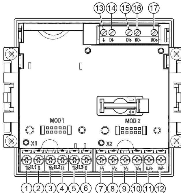
Bild 6-3 Klemmenbeschriftung mit Schraubklemmen
