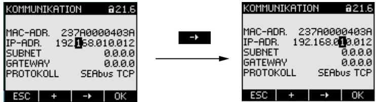
Bild 8-23 Mehrstellige Werte definieren
