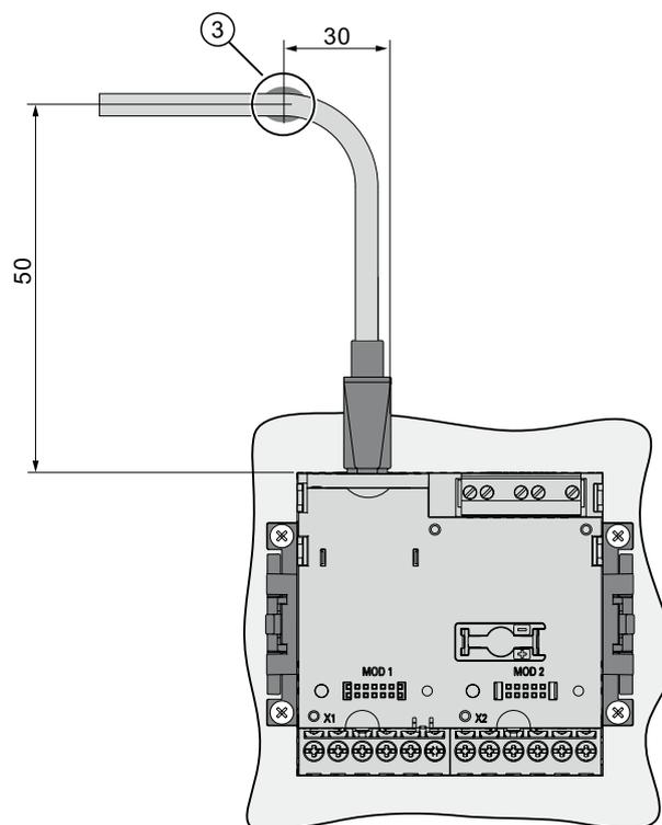
Bild 5-1 Montageschritt E - Zugentlastung für RJ45-Stecker
