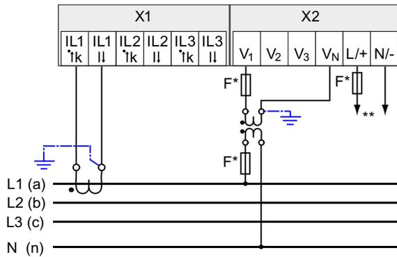
Bild 6-11 Anschlussart 3P4WB, mit Spannungswandler, mit einem Stromwandler
