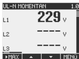
Bild 3-3 Anzeige der Messspannung bei Anschlussart 1P2W
