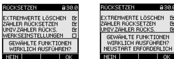
Bild 9-23      Geräteeinstellung "RÜCKSETZEN"
