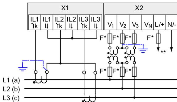
Bild 6-15 Anschlussart 3P3W, mit Spannungswandler, mit zwei Stromwandlern
