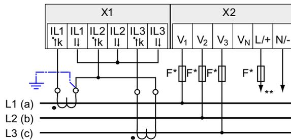
Bild 6-14 Anschlussart 3P3W, ohne Spannungswandler, mit zwei Stromwandlern
