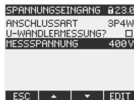
Bild 7-8 Geräteeinstellung "MESSSPANNUNG"
