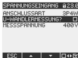
Bild 7-5 Geräteeinstellung "U-WANDLERMESSUNG?"
