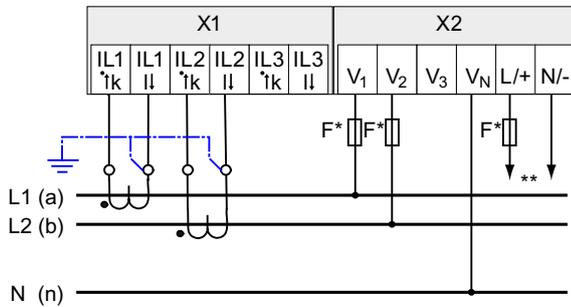
Bild 6-18 Anschlussart 3P4W, ohne Spannungswandler, mit zwei Stromwandlern
