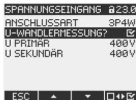
Bild 7-6 Geräteeinstellung "U-WANDLERMESSUNG?"
