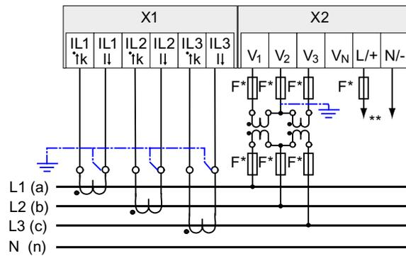
Bild 6-20 Anschlussart 3P3W, mit Spannungswandler, mit drei Stromwandlern
