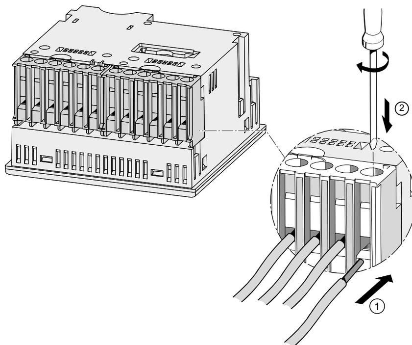
Bild 6-6 Anklemmen der Leitungen an der Schraubklemme
