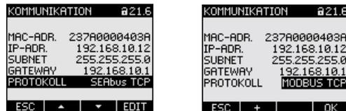
Bild 3-11 Umschalten des Protokolls auf Modbus TCP
