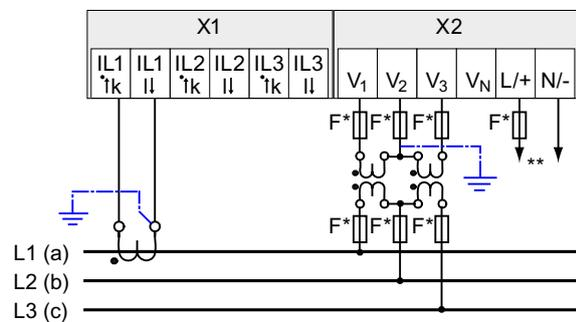
Bild 6-17 Anschlussart 3P3WB, mit Spannungswandler, mit einem Stromwandler
