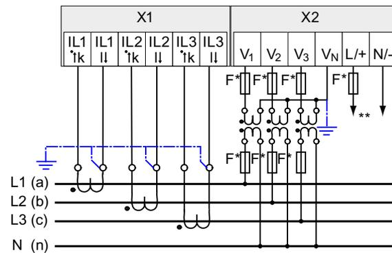
Bild 6-9 Anschlussart 3P4W, mit Spannungswandler, mit drei Stromwandlern
