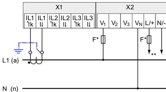
Bild 6-19 Anschlussart 1P2W, ohne Spannungswandler, mit einem Stromwandler
