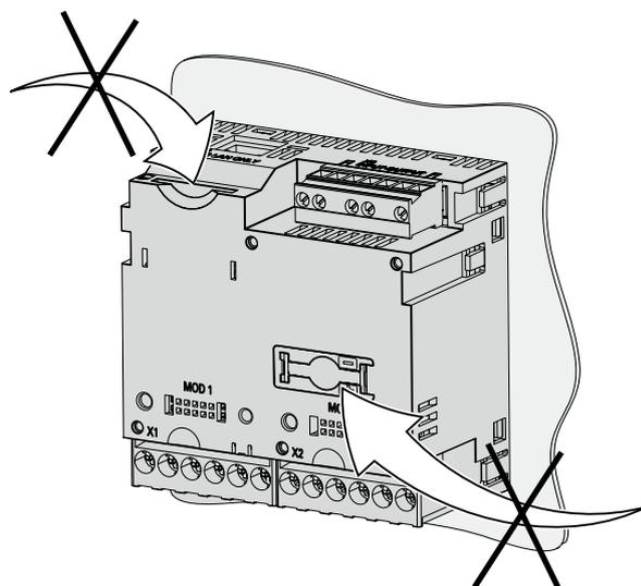
Bild 3-14 Nicht nutzbar! Einschuböffnung für Speicherkarte und Batteriefach
