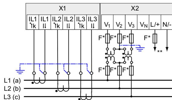
Bild 6-13 Anschlussart 3P3W, mit Spannungswandler, mit drei Stromwandlern
