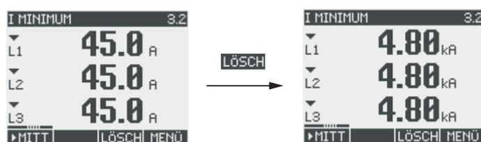
Bild 8-13 Minimal- oder Maximalwert auf Momentanwert zurücksetzen
