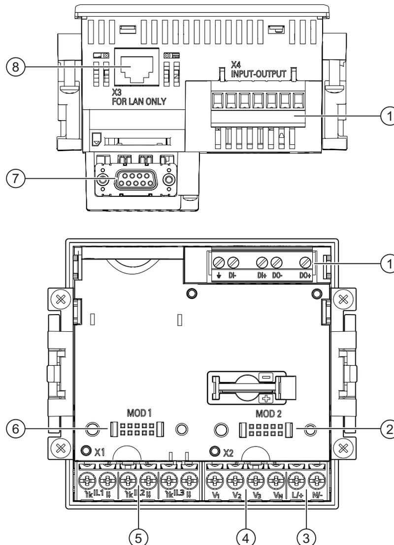
Bild 6-1 Anschlussbezeichnungen, Ansicht der Rück- und Oberseite des Geräts mit Schraubklemmen
