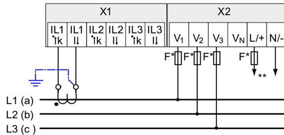
Bild 6-16 Anschlussart 3P3WB, ohne Spannungswandler, mit einem Stromwandler
