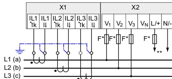
Bild 6-12 Anschlussart 3P3W, ohne Spannungswandler, mit drei Stromwandlern
