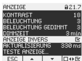
Bild 9-15 Geräteeinstellung "ANZEIGE INVERS" eingeschaltet
