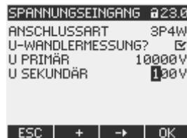
Bild 7-7 Geräteeinstellung "SPANNUNGSEINGANG"
