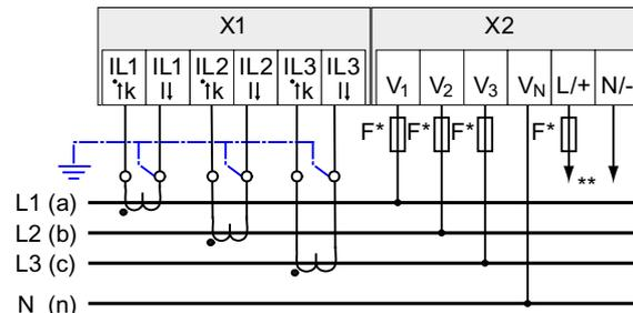
Bild 6-8 Anschlussart 3P4W, ohne Spannungswandler, mit drei Stromwandlern
