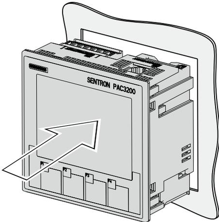
Montageschritt A, Gerät mit Schraubklemmen
