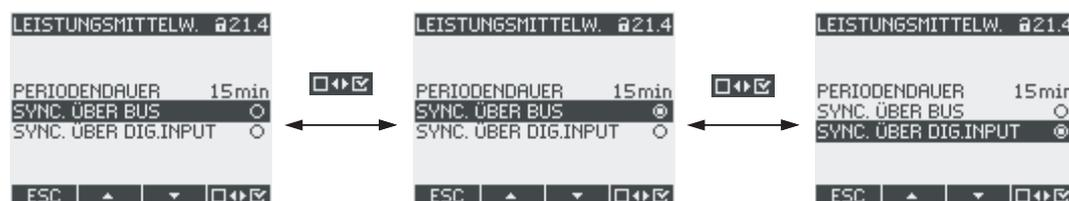
Bild 8-21 Geräteeinstellung, Umschalten zwischen mehreren Alternativen
