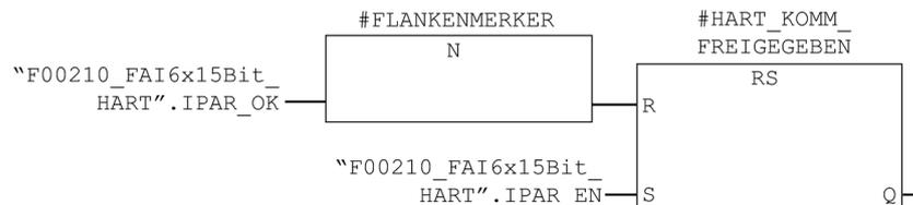
Bild 9-47 Beispiel zur Freigabe der HART-Kommunikation in S7 Distributed Safety
