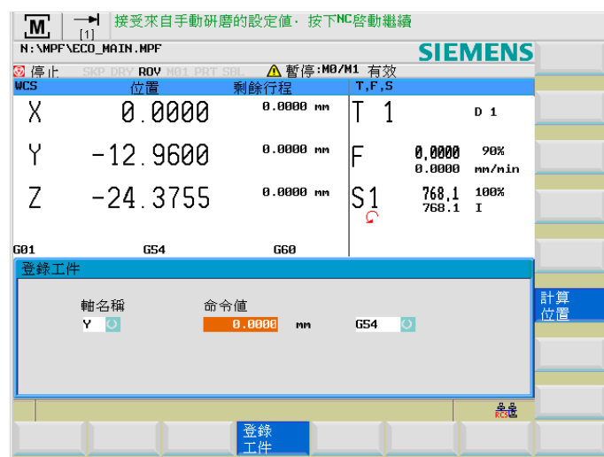
圖像 4-15 手動研磨後測量工件
