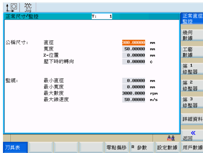
圖像 4-6 研磨輪載明規格和監控資料
