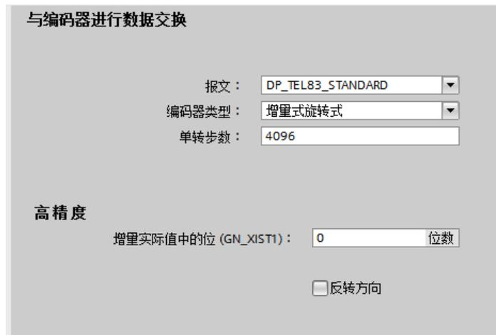
图 3-7 填写编码器参数
