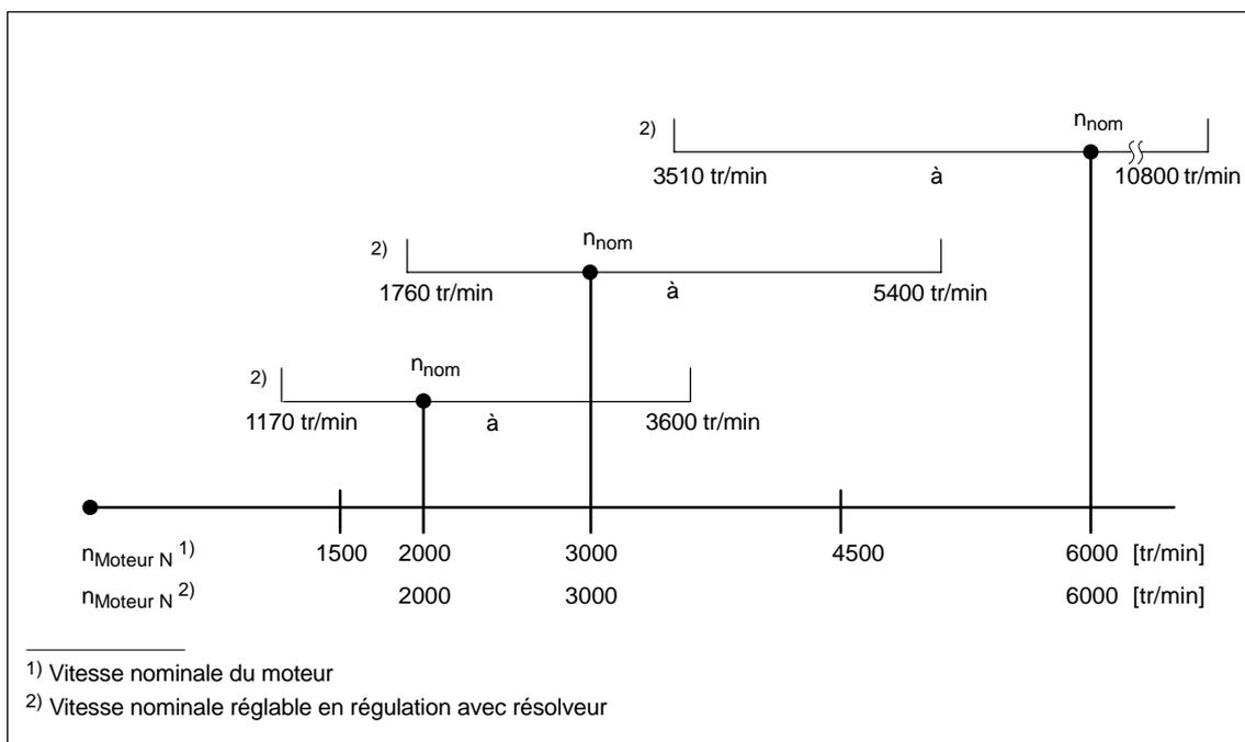
Figure 2-1 Plages de réglage pour une consigne de vitesse de  $\pm 10$  V
