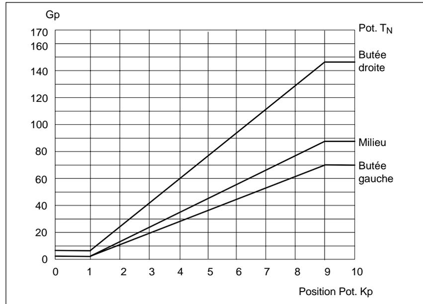
Figure 2-2 Gain proportionnel  $G_p$  en fonction des potentiomètres  $K_p$  et  $T_N$
