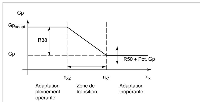
Figure 2-6 Dépendance entre gain proportionnel Gp et vitesse
