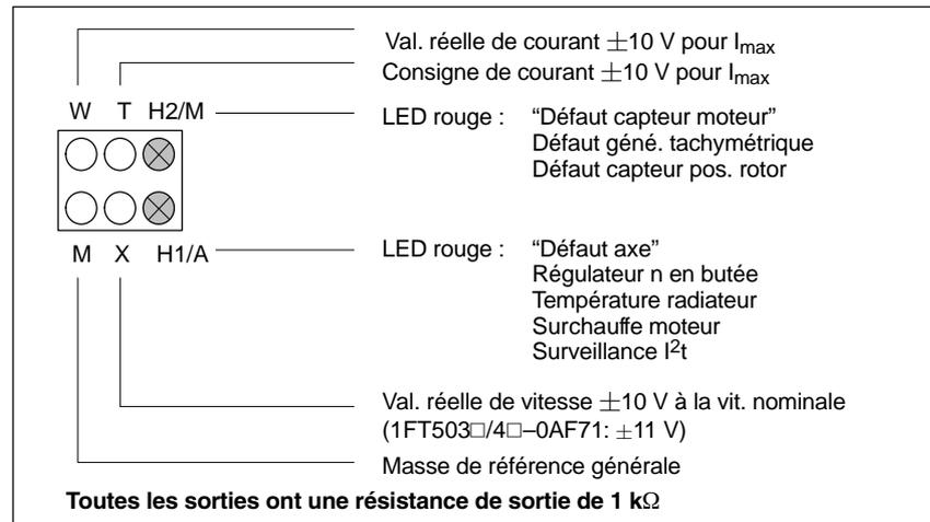
Figure 8-2 Douilles de mesure, interface standard
