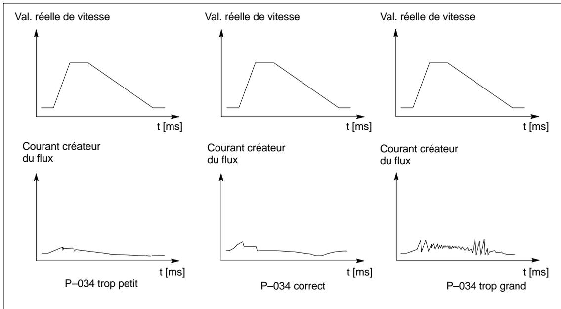
Figure 4-4 Optimisation du régulateur de flux
