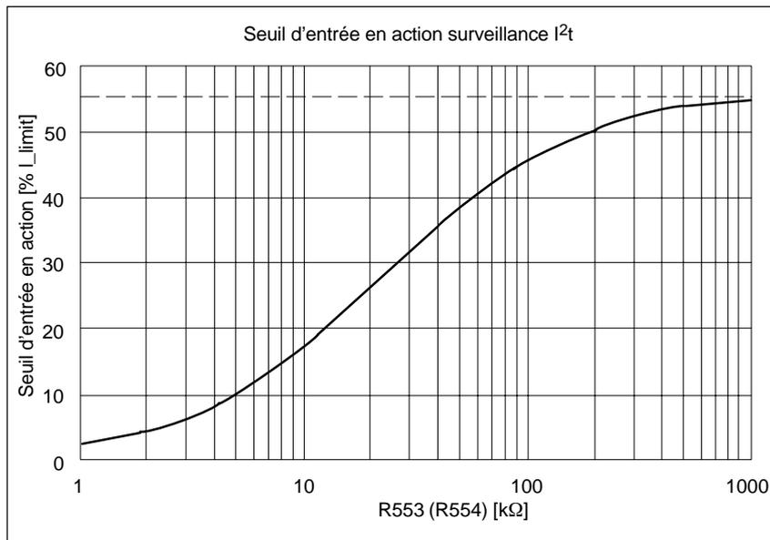
Figure 3-2 Seuil d'entrée en action de la surveillance I<sup>2</sup>t
