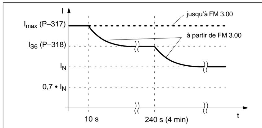
Figure 2-3 Caractéristique pour le paramétrage standard de la limitation I<sup>2</sup>t
