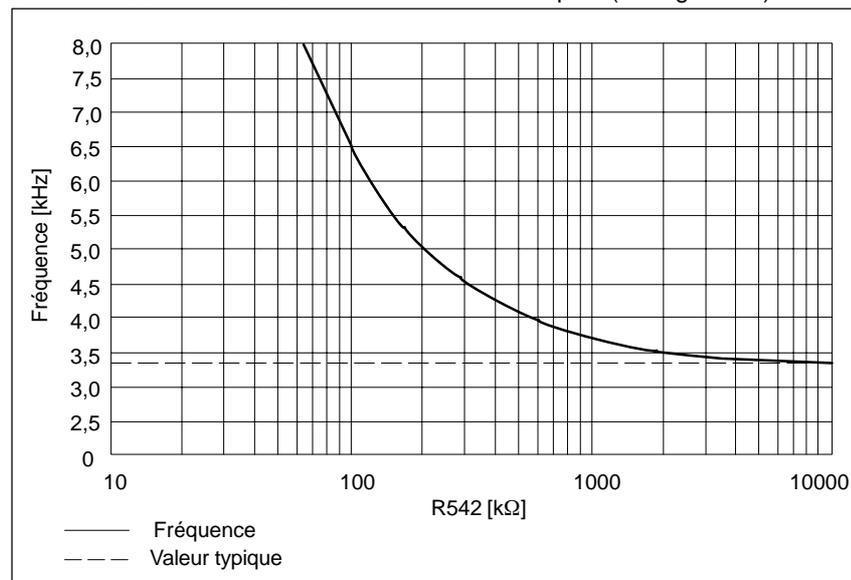
Figure 3-1 Fréquence de modulation de l'onduleur
