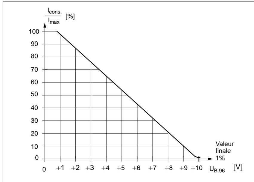
Figure 3-4 Limitation de la consigne de courant en fonction de la tension appliquée à la borne 96 (R12 = retirée)
