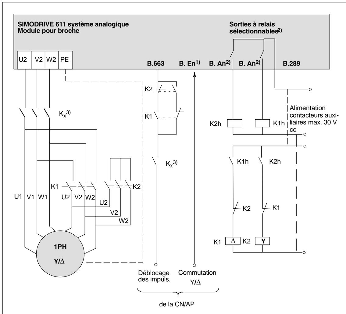
Figure 6-2 Schéma des connexions pour la commutation Y/Δ
