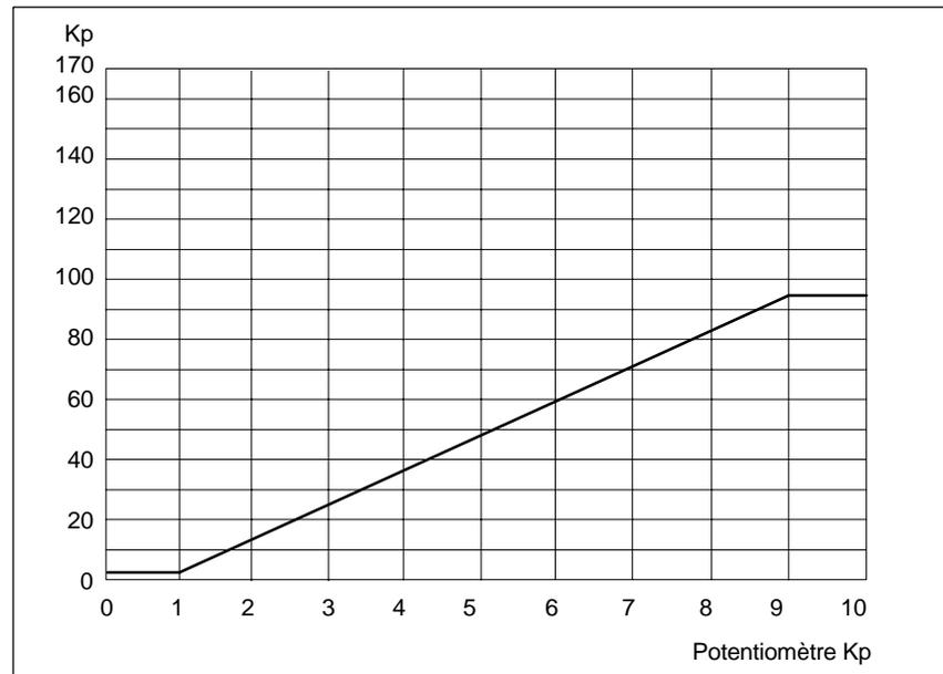
Figure 2-2 Gain proportionnel Gp en fonction de la position du potentiomètre K
