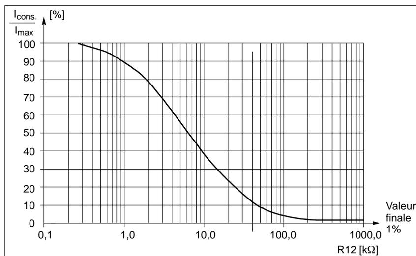
Figure 3-3 Limitation de la consigne de courant en fonction de R12, |30 V| ≥ borne 96 ≥ |12 V|
