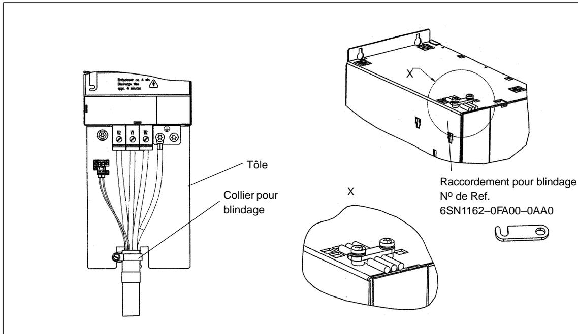
Figure 2-1 Colliers de raccordement pour blindage
