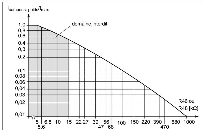
Figure 3-7 Consigne additionnelle de courant pour la compensation électrique de poids
