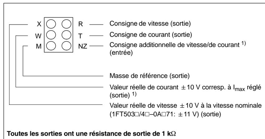
Figure 8-1 Douilles de mesure, interface sophistiqué
