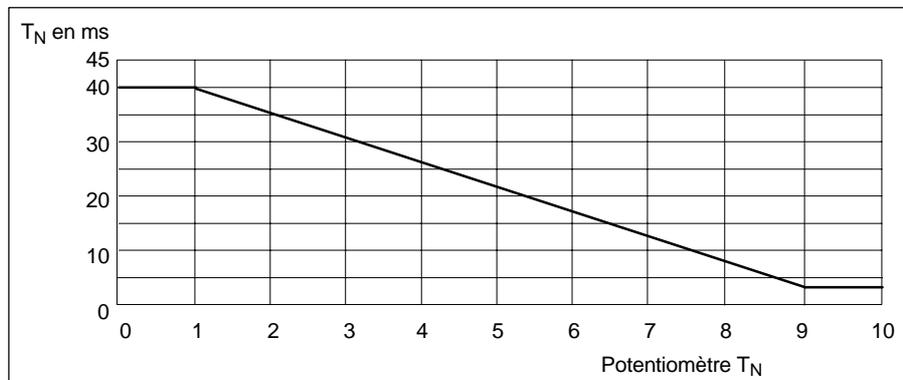
Figure 2-3 Temps d'intégration  $T_N$  en fonction du potentiomètre  $T_N$
