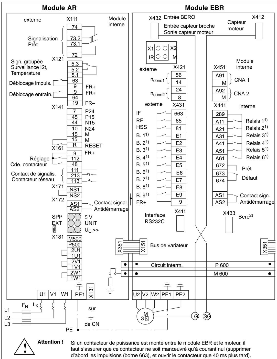
Figure 6-1 Schéma de branchement
