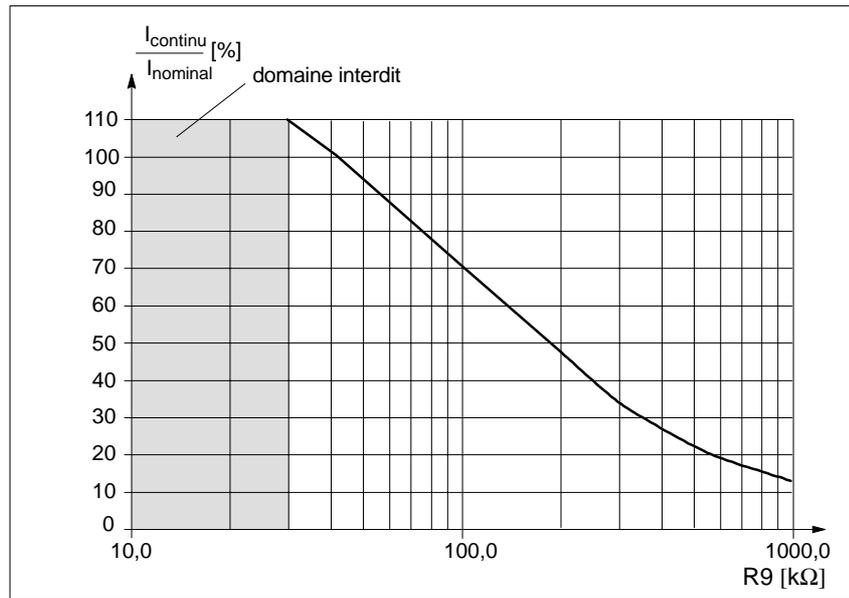
Figure 3-6 Seuil d'entrée en action de la surveillance I<sup>2</sup>t en fonction de R9
