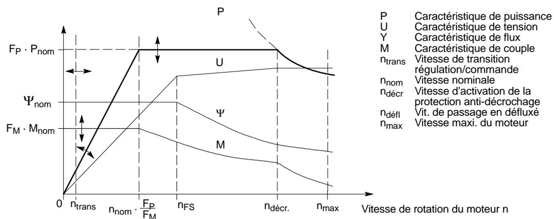
La limite de couple et de puissance peut être déplacée en agissant sur le facteur  $F_M$  (paramètres P-039, P-041) ou  $F_P$  (P-060). On obtient les plages de vitesse suivantes :
