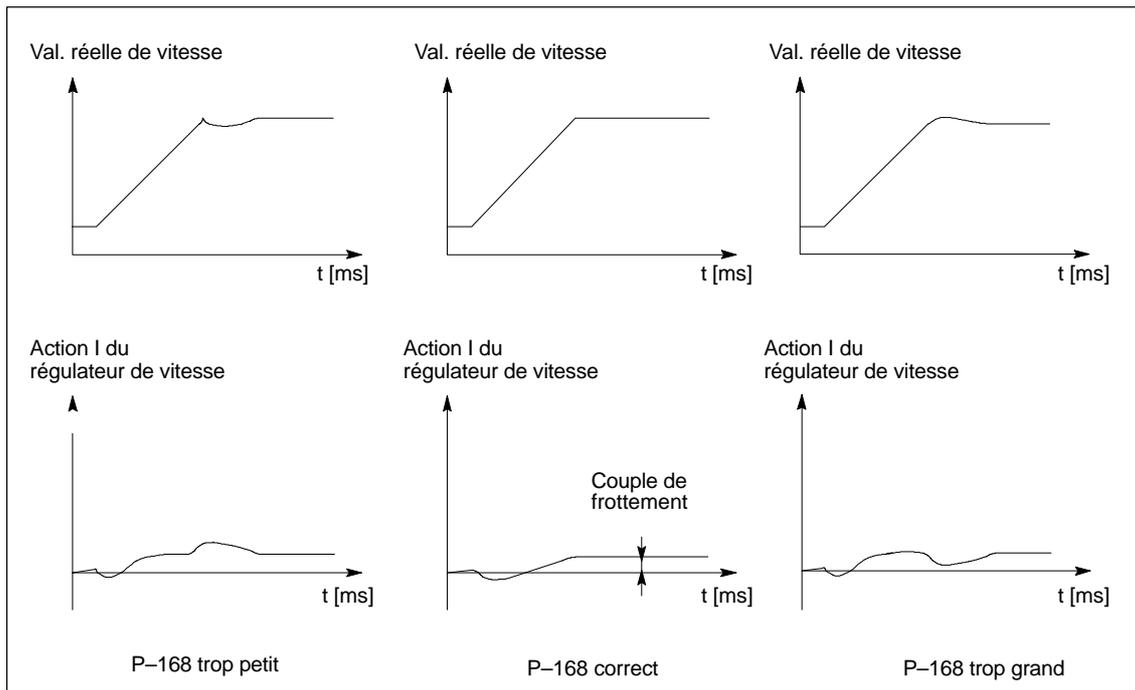
Figure 4-7 Optimisation de la résistance rotorique du moteur
