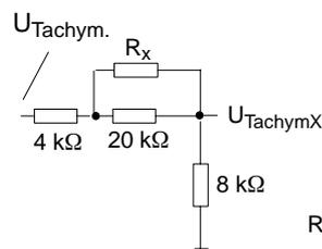
La tension tachym.  $U_{\text{Tachym.}}$  vaut normalement 40 V pour la vitesse nominale, ce qui donne une tension  $U_{\text{Tachym.X}}$  de 10 V. Pour une vitesse utile différant nettement de la vitesse nominale du moteur, il est possible d'effectuer un réglage conformément à ce critère.
