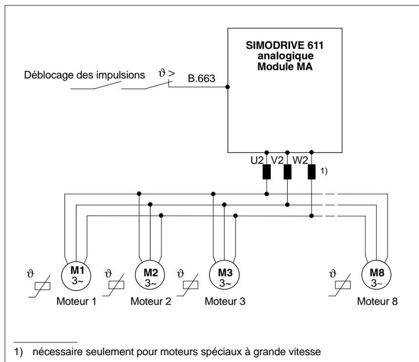
Figure 2-1 Marche en parallèle sur le module MA de SIMODRIVE 611 analogique
