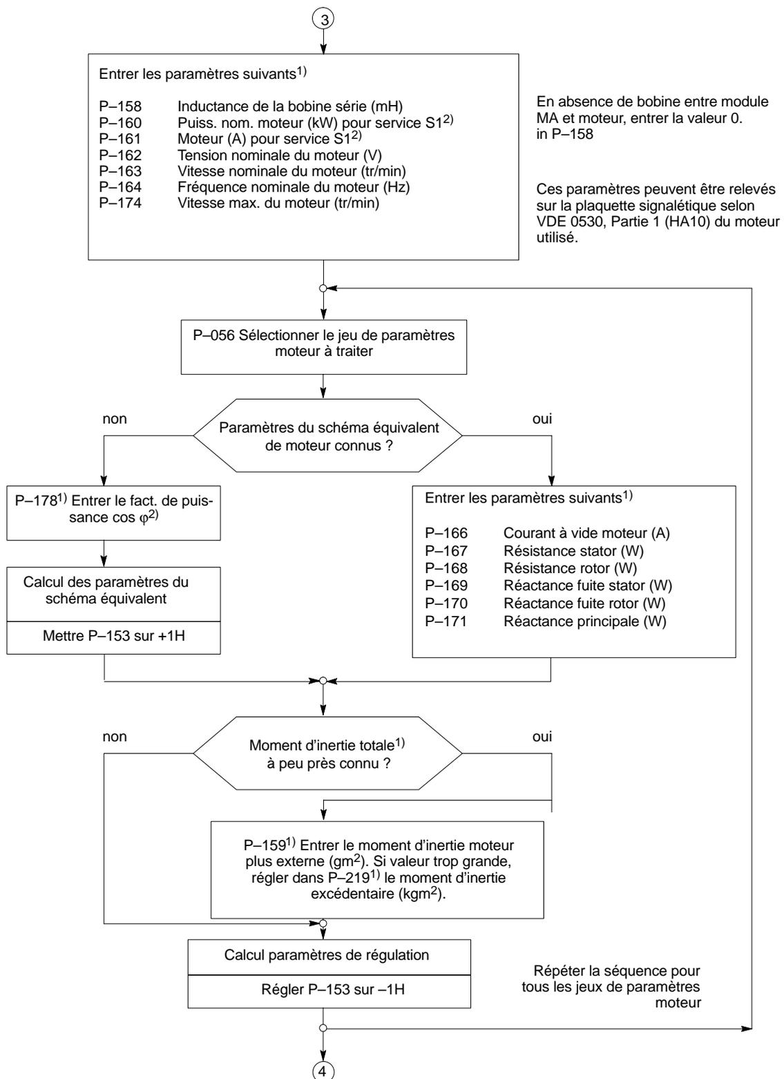
1) on peut entrer les paramètres pour quatre moteurs différents (sous-paramètres 1 à 4)
