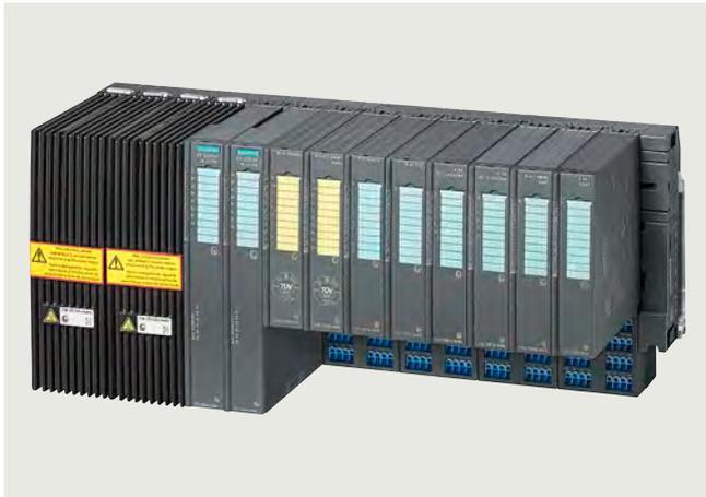
Das ET 200iSP ist ein modulares, eigensicheres I/O-Peripheriesystem in Schutzart IP30, das in Gas- und Staubatmosphären bei Umgebungstemperaturen von -20 bis +70 °C betrieben werden kann. Es ist für die Verwendung mit SIMATIC PCS 7 und PCS neo optimiert, lässt sich aber mittels GSD/GSDML-Datei auch in andere Systeme einbinden, z. B. in SIMATIC S5.
