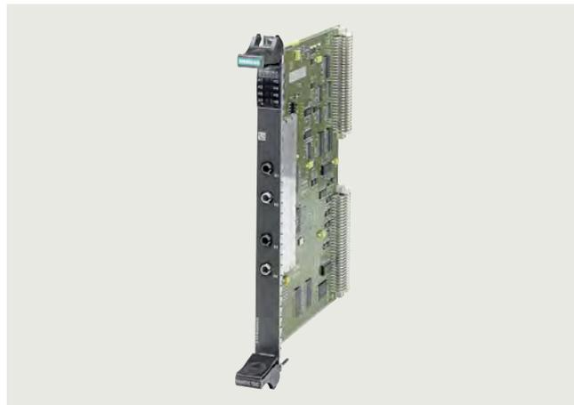
Die Kopplungsbaugruppe CP53M0 ermöglicht die Ankopplung eines SIMATIC TDC-Systems an ein SIMADYN D-System für einen schnellen Datenaustausch, z. B. bei der Erweiterung von bestehenden SIMADYN D-Anlagen.
