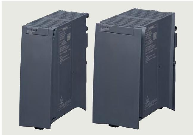
Die einphasige Laststromversorgung SIMATIC PM 1507 (PM = Power Modul) mit automatischer Bereichsumschaltung der Eingangsspannung ist in Design und Funktionalität optimal an die Steuerung SIMATIC S7-1500 angepasst. Sie versorgt die S7-1500-Systemkomponenten wie CPU, Systemstromversorgung (PS), Ein-/Ausgabestromkreise der E/A-Module und gegebenenfalls die Sensorik und Aktorik mit DC 24 V.
