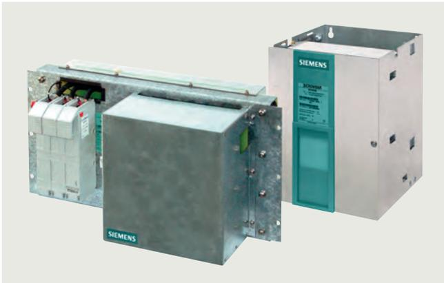
**SICROWBAR AC** wird zum Schutz von Leistungshalbleitern in Stromrichtern (Thyristoren und Dioden) vor Überspannungen zwischen den Phasen eines Drehstromnetzes eingesetzt. Der Anwendungsbereich beschränkt sich nicht nur auf den Schutz von Stromrichtern für die DC-Antriebstechnik, sondern umfasst ebenso die thyristorbestückten Einspeise-/Rückspeiseeinheiten der AC-Antriebstechnik.
