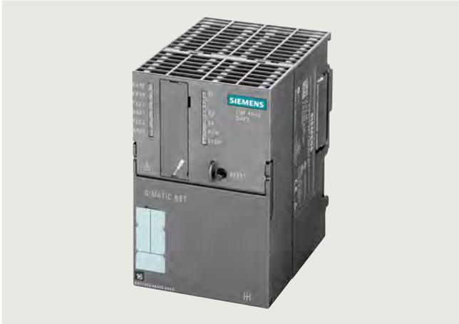
Die Kommunikationsbaugruppe SIPLUS TIM 4R-IE DNP3 (Telecontrol Interface Module) wickelt in einer Station für die S7-CPU den Datenverkehr zu dem zugeordneten Master-System SIMATIC PCS7 TeleControl V8.0 mit dem offenen DNP3-Protokoll ab. Zusätzlich unterstützt die Baugruppe mit der V3.0 nun auch die Master- und Knotenfunktionalität.
