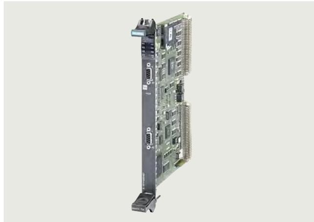
Die Kommunikationsbaugruppe CP50M1 bietet zwei PROFIBUS DP/MPI-Schnittstellen und 8 MByte Koppelspeicher für die Kommunikation der CPUs untereinander. Die Schnittstellen können dabei als PROFIBUS DP-Master, Slave, als Master und Slave gleichzeitig oder als MPI-Teilnehmer verwendet werden.
