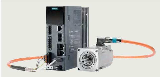
Das Servoantriebssystem besteht aus einem SINAMICS S210 Servo-Umrichter, einem SIMOTICS S-1FK2, S-1FT2 oder S-1FS2 Servomotor und einer zugehörigen Ein-Kabel-Technik-Verbindungsleitung (One Cable Connection – OCC) zum Anschluss des Motors an den Umrichter. SINAMICS S210 ist ein Einachs-AC/AC-Servo-Umrichtersystem mit hoher Performance und Dynamik für Midrange Motion Control Applikationen.
