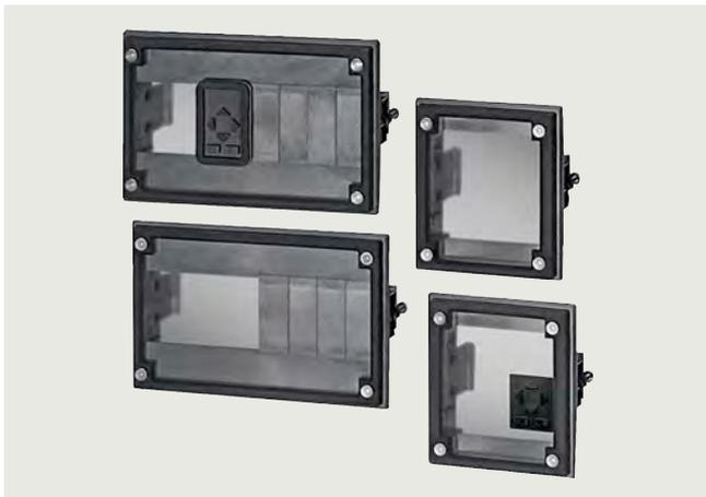
LOGO! und SIPLUS LOGO! sind für die schnelle und einfache Hutschienenmontage konzipiert. Mit dem Einbausatz können diese Geräte auch in Fronttafeln einfach und sicher eingebaut werden. Bei Verwendung der mitgelieferten Scheibe und Dichtungen sind die Geräte sogar vor rauen Umgebungen bis Schutzart IP65 sicher geschützt.
