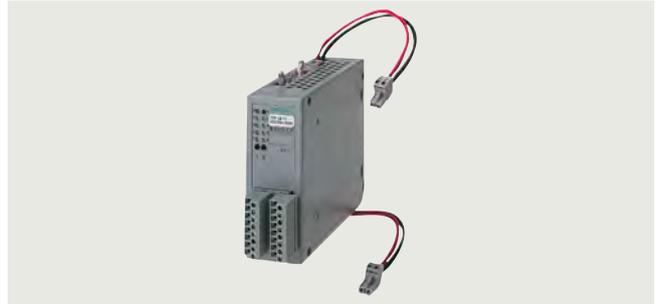
Das Interfacemodul dient zum Anschluss von 8 Digitalausgängen mit Wandlung der baugruppenseitigen DC 24 V auf anlagenseitig max. DC/AC 120 V mittels Relais.
