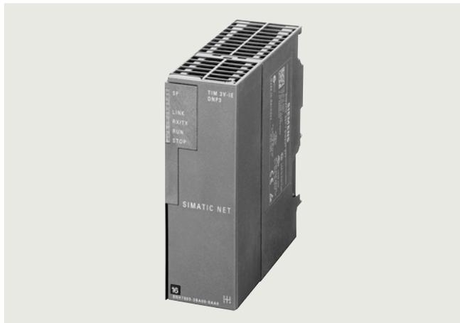
Die Kommunikationsbaugruppe TIM 3V-IE DNP3 (Telecontrol Interface Module) wickelt in einer Station für die S7-CPU den Datenverkehr zu dem zugeordneten Master- System SIMATIC PCS 7 TeleControl V8.0 mit dem offenen DNP3-Protokoll ab. Zusätzlich unterstützt die Baugruppe auch die Master- und Knotenfunktionalität.
