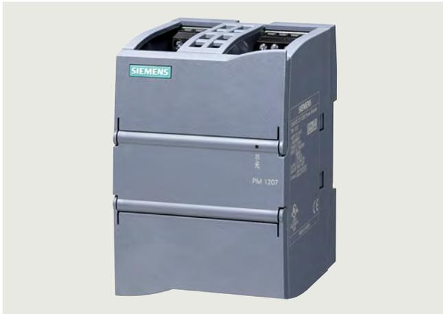
Die einphasige Laststromversorgung SIMATIC PM 1207 (PM = Power Modul) mit automatischer Bereichsumschaltung der Eingangsspannung ist in Design und Funktionalität optimal an die Steuerung SIMATIC S7-1200 angepasst. Sie versorgt CPUs mit 24-V-Eingang, Signalmodule und daran angeschlossene 24-V-Verbraucher. Umfangreiche Zertifizierungen wie UL und DNV GL ermöglichen einen universellen Einsatz.
