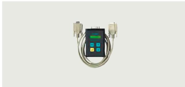
Das Service Tool kann für die Eingabe von Fahrbefehlen, zum Ändern der Fahrparameter und zum Auslesen der gelernten Parameter, der Türzustände, der Eingangs- und Ausgangssignale und der Servicedaten verwendet werden.
