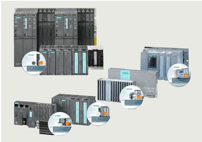
Soll eine SIMATIC S7-300-basierte Anlage mit einer Siemens-Leitstelle, z. B. SIMATIC PCS 7 TeleControl, WinCC TeleControl, WinCC OA, oder der Leitstelle eines Drittanbieters, über den Fernwirkstandard IEC 60870-5 kommunizieren, können die Fernwirkprotokolle IEC 60870-5-101 (seriell), -103 (Schutz) bzw. -104 (TCP/IP) in den SIMATIC-Automatisierungssystemen eingesetzt werden.
