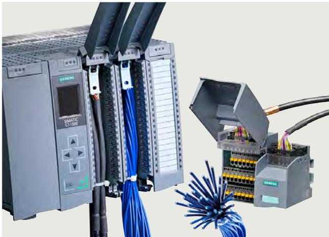
SIMATIC TOP connect sorgt mit zwei Verkabelungssystemen für die effiziente Verdrahtung der Ein- und Ausgabebaugruppe der SIMATIC S7-1500 (35 mm Bauform): Der vollmodulare Anschluss für die schnelle und übersichtliche Verbindung mit den Sensoren und Aktoren aus dem Feld, sowie der flexible Anschluss für die einfache Verdrahtung innerhalb des Schaltschranks.
