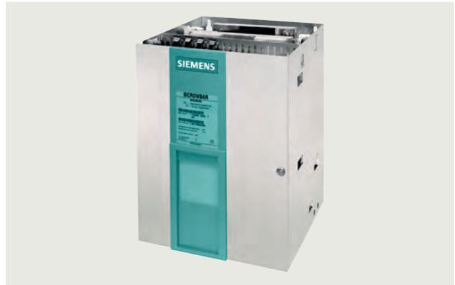
**SICROWBAR DC** schützt Wicklungen und Stromrichter gegen Überspannung bei Speisung großer Induktivitäten, z. B. Erregerwicklungen von Synchronmaschinen, Gleichstrommaschinen oder Hubmagnete. Ein entsprechender Entreger-/Entladewiderstand ist vorzusehen. Der Thermoschalter ist als Option zum Widerstand beim Hersteller bestellbar.
