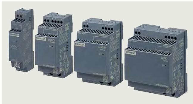
Die Produktlinie LOGO!Power ist mit ihrer stufenförmigen Bauform insbesondere für den Einsatz in Installations-Kleinverteiltern geeignet. Die geregelten Stromversorgungen mit Weitbereichseingang stehen mit einer Ausgangsspannung von 24 V in vier Leistungsklassen zur Verfügung. Die 24-V-Varianten eignen sich optimal zur Versorgung von LOGO!-Steuerungen mit entsprechendem Spannungseingang.
