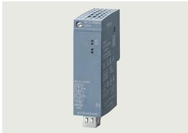
SIMATIC BusAdapter BA LC-LD/M12 für den Einsatz als systemintegrierter Medienkonverter von Kupfer (M12) auf Singlemode-Glasfaser (LC-LD)
