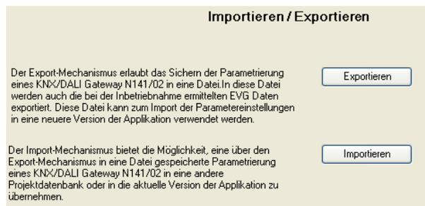
Der Exportmechanismus ermöglicht das Sichern der Parametrierung eines KNX/DALI Gateway N141/02 in eine Datei. In diese Datei werden auch die bei der Inbetriebnahme ermittelten EVG Daten exportiert. Diese exportierten Nummern, Namen und Gruppenzuordnungen gelten jedoch nur solange, wie bei dem zugehörigen KNX/DALI Gateway N141/02 kein erneutes Initialisieren von EVGs durchgeführt bzw. keine andere Applikation in das Gerät geladen wurde.
