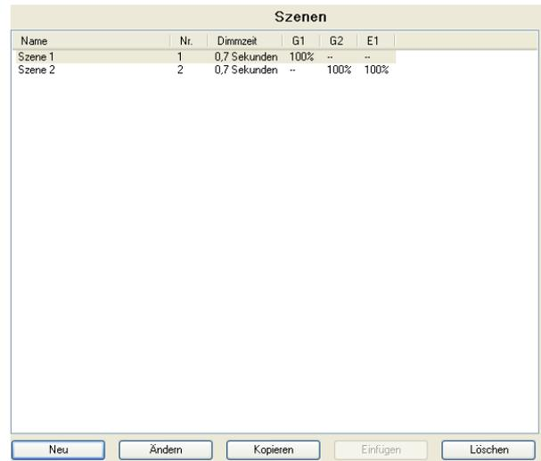
Das Parameter-Fenster „Szenen“ ermöglicht eine Übersicht, wie viele Szenen bereits parametrisiert wurden und welche Gruppen jeweils in eine Szene eingebunden sind. Wird der Cursor in die erste Zeile unter die Spaltenbezeichnung „Name“ gesetzt, so wird eine Zeile mit den Erläuterungen der in der Kopfzeile verwendeten Abkürzungen eingeblendet.
