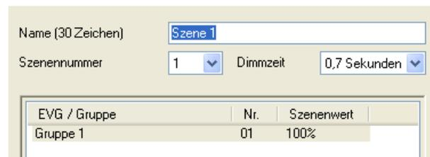
Mit der Schaltfläche „Neu“ kann im Fenster „Szene, Parameter“ eine neue Gruppe oder EVG hinzugefügt werden. Durch Doppelklick auf einen Listeneintrag oder
