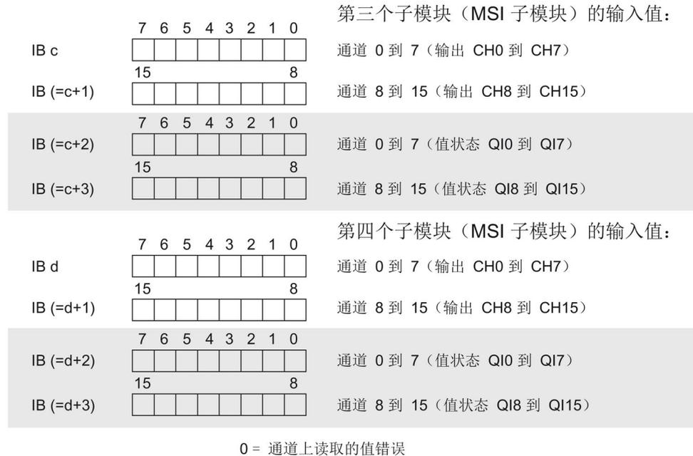
图 4-4 组态为带值状态的 1 x 16 通道 DI 16x24VDC BA MSI 的地址空间
