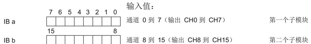
图 4-2 组态为 2 x 8 通道 DI 16x24VDC BA S 的地址空间
