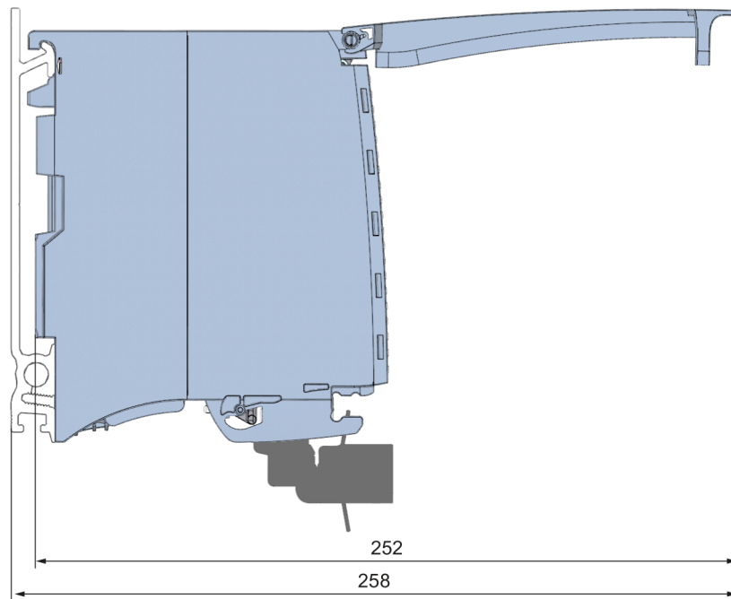
Figura A-2 Croquis acotado del módulo AI 8xU/I/RTD/TC ST, vista lateral con tapa frontal abierta
