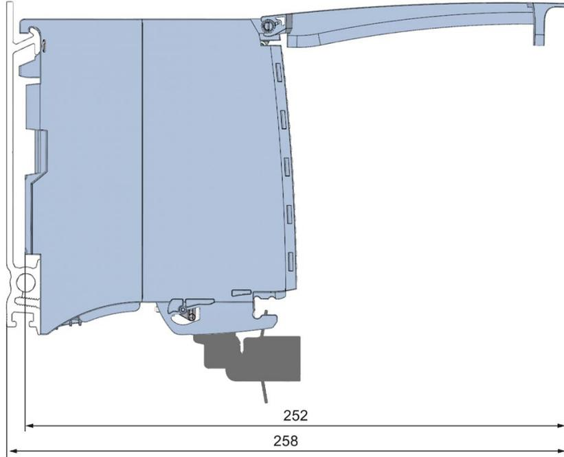
图 A-2 AI 8xU//RTD/TC ST 模块的尺寸图，带开放式前面板的侧视图
