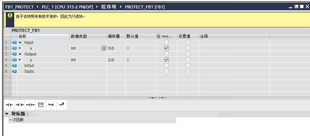
图 1-5 无密码时被保护程序块的状态
