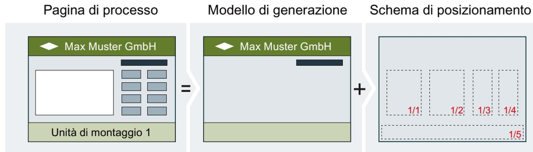
I campi di posizionamento vengono raggruppati in un'unità logica assegnando loro lo stesso nome. All'interno di un'unità logica i campi di posizionamento vengono riempiti nella sequenza dell'indice.
