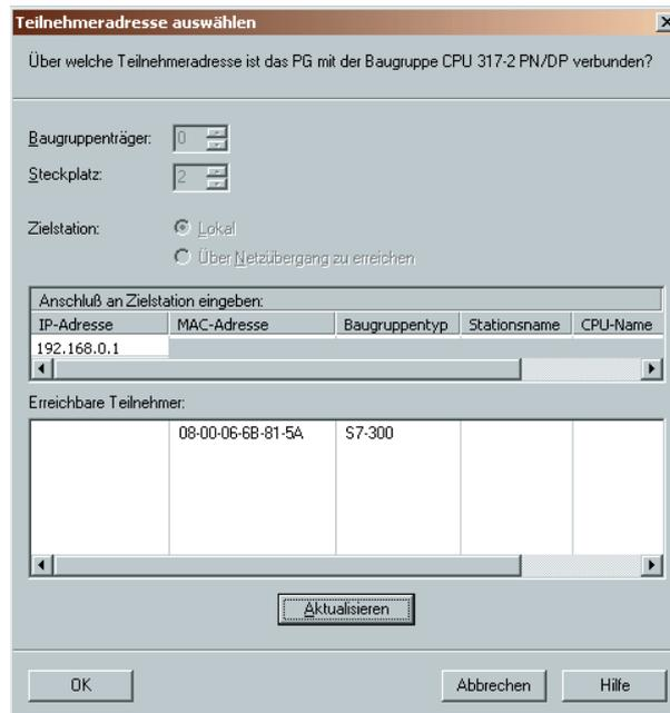
5. Markieren Sie die Zeile mit der MAC-Adresse der CPU. Betätigen Sie mit "OK".
