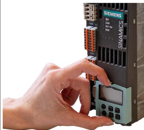
4. Premere contemporaneamente le linguette di incastro sul BOP20 e inserirlo direttamente nella CU305 fino a farlo scattare in posizione.
