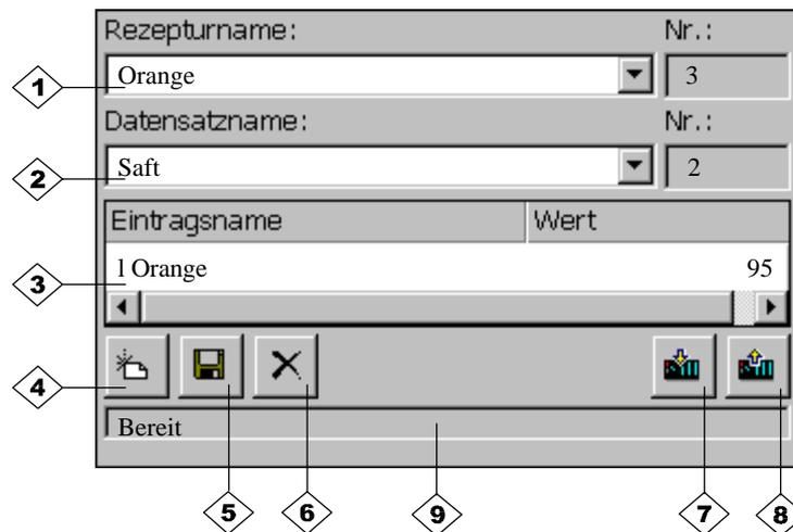
Bild 7-16 Aufbau der Rezepturanzeige (Beispiel)
