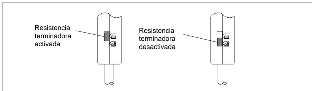
Figura 5-3 Resistencia terminadora del conector de bus
