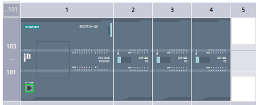
Bild 6-1 Gerätekonfiguration für Maximalausbau mit drei Signalmodulen
