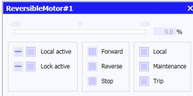
Im Bedienfenster der Komponente ist der aktuelle Drehzahlwert des Antriebs in Form einer Balkenanzeige visualisiert.
