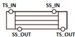
Bild 9-23 Symbol des Komponententyps HeatExchangerShellTube
