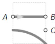
Die graue Pfeilspitze im Symbol zeigt die Bezugsrichtung für die Bewegung der Fahrzeuge an. Das Symbol kann zur Einstellung der Größe der Weiche in seiner Größe proportional skaliert werden. Durch die proportionale Skalierung werden die Länge der Weiche und der Radius des Abzweigs verändert, der Winkel des Abzweigs von 45° ändert sich nicht.
