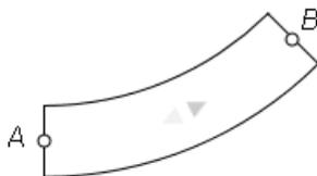
Die graue Pfeilspitze im Symbol zeigt die Bezugsrichtung für die Bewegung der Fördergüter an. Bei laufender Simulation wird die aktuelle Transportrichtung durch grüne Pfeile im Symbol angezeigt.
