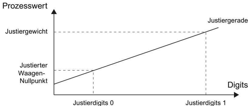
Der erste Justierpunkt ist durch die unbelastete (leere) Waage allein mit ihrem Konstruktionsgewicht bestimmt, der zweite Punkt ist durch das gewählte Justiergewicht bestimmt. Die entsprechenden normierten Zahlenwerte werden als Justierdigits 0 und Justierdigits 1 im Wägemodul gespeichert.
