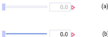
Controls werden wie Komponenten auf Diagrammen durch das typspezifische Symbol repräsentiert. Zur Selektion klicken Sie einfach auf das Symbol. Das Symbol des selektierten Controls wird dann mit einem blauen Selektionsrahmen dargestellt und kann mit gedrückter linker Maustaste auf dem Diagramm verschoben werden. Über Anfasser am Selektionsrahmen kann die Größe des Symbols verändert werden.
