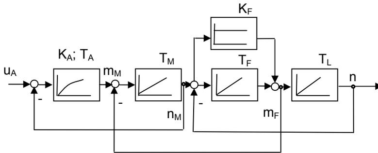
With damping,  $m_F = (n_M - n_L) / (pT_F) + k_F * (n_M - n_L)$
