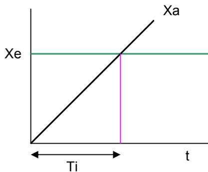
$X_e$ : input variable;  $X_a$ : output variable
