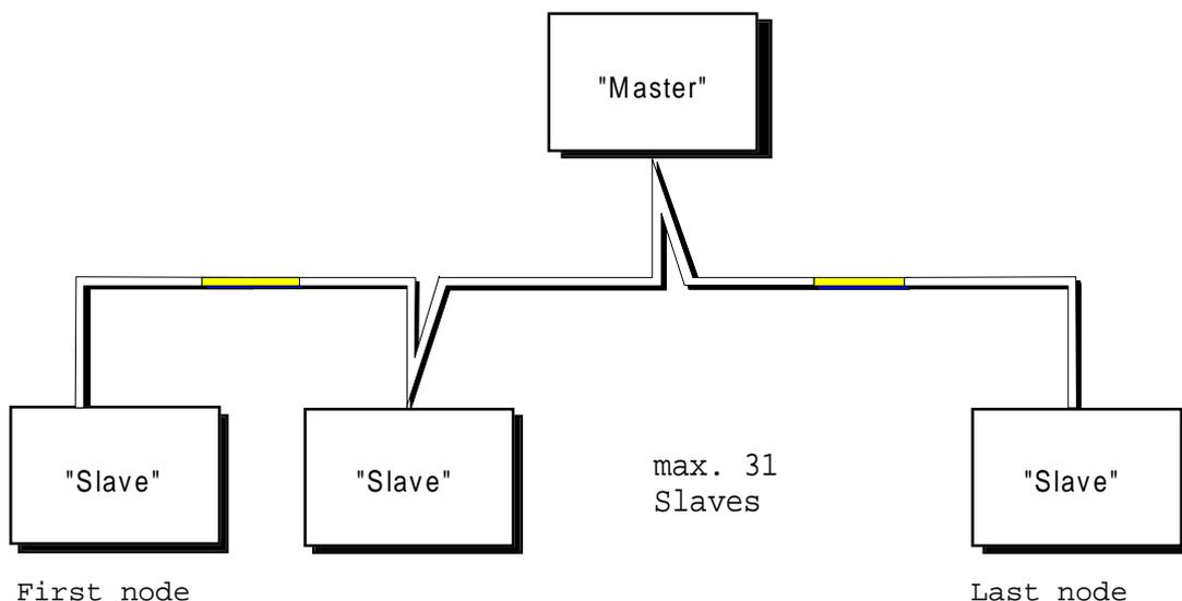
Fig. 1.1: Topology, USS<sup>®</sup> bus
