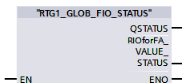
Abbildung 3-7: Systemgenerierter Baustein zur globalen Auswertung der F-Peripherien
