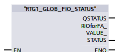
Abbildung 3-9: Systemgenerierter Baustein zur globalen Auswertung der F-Peripherien
