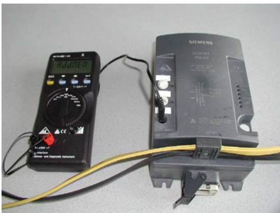
Anschluss eines Adressier- und Diagnosegeräts am Beispiel eines Motorstarters
