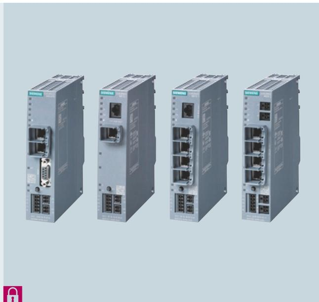
Das SCALANCE M-Portfolio besteht aus Routern für Applikation für Industrial Remote Communication, wie Telecontrol und Teleservice. Die integrierten Security-Funktionen Firewall und VPN (IPsec; OpenVPN als Client und zur Anbindung an SINEMA Remote Connect) schützen vor unbefugten Zugriffen und sichern die Datenübertragung.
