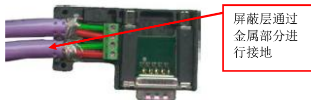
图23 PROFIBUS 插头内部接线即屏蔽层的处理
