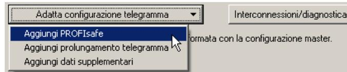
Figura 5-10 Aggiunta del telegramma PROFIsafe nell'azionamento
