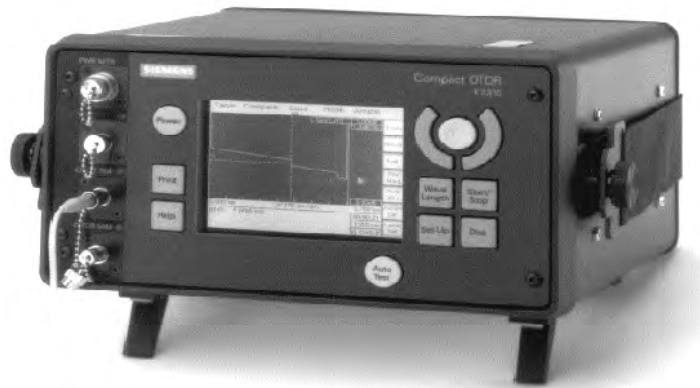
Bild A-3 Optical Time Domain Reflectometer (OTDR)
