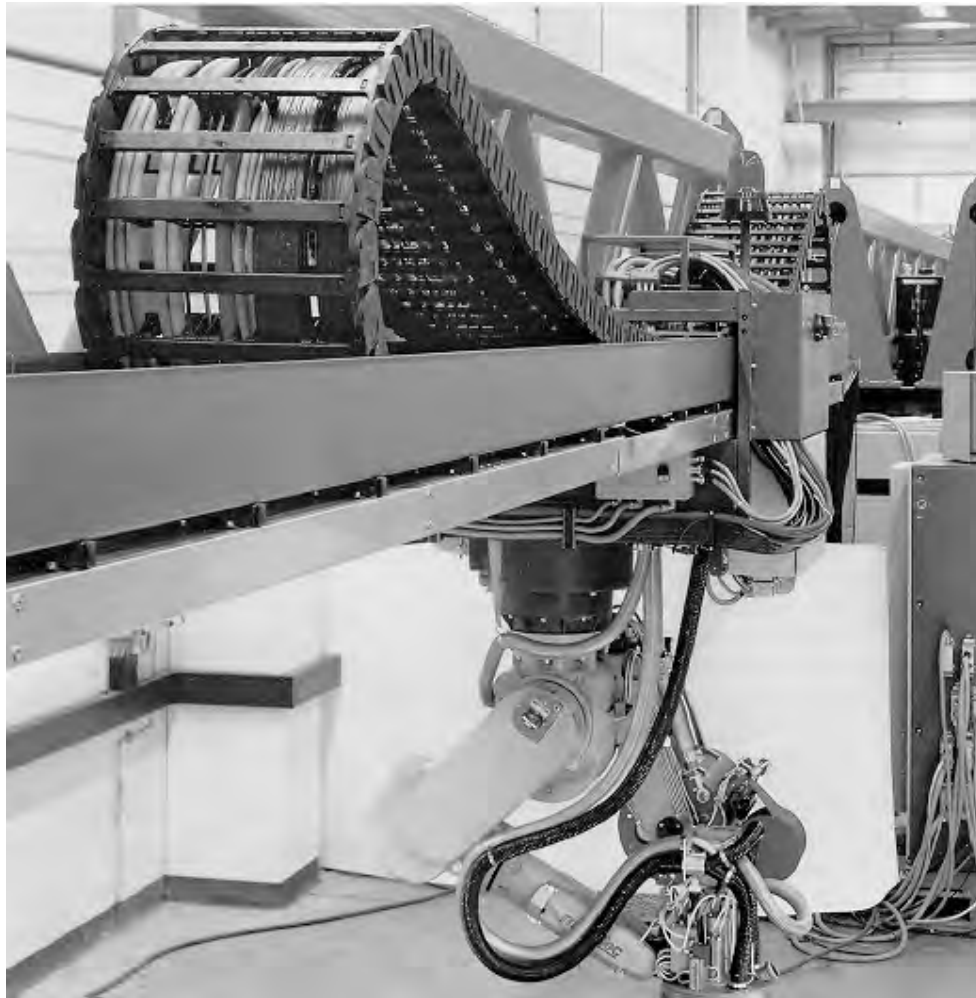
Bild 4-8 Einsatzbeispiel PROFIBUS Schleppleitung in einer Schleppkette
