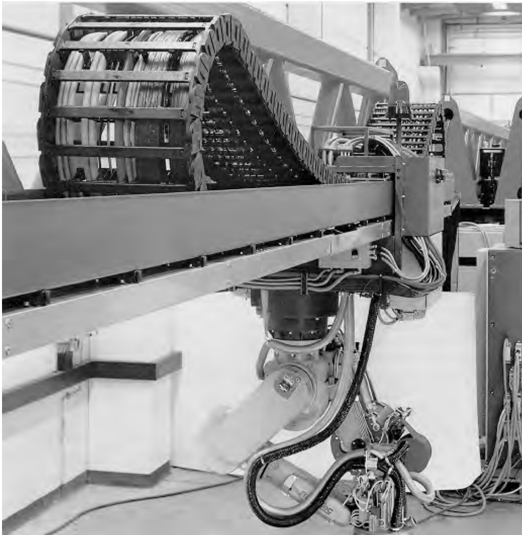
Bild 7-7 Einsatzbeispiel Glas-LWL Schleppleitung in einer Schleppkette
