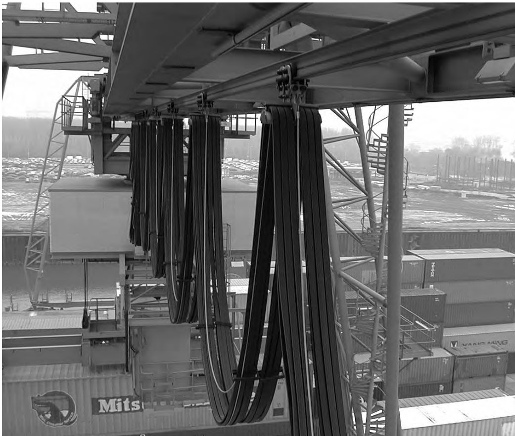
Bild 4-11 Einsatzbeispiel für PROFIBUS Leitung für Girlandenaufhängung
