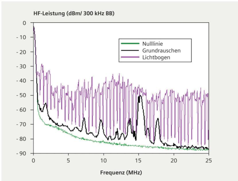
Bild 22: Hochfrequenzrauschen: Grundrauschen und Lichtbogen
