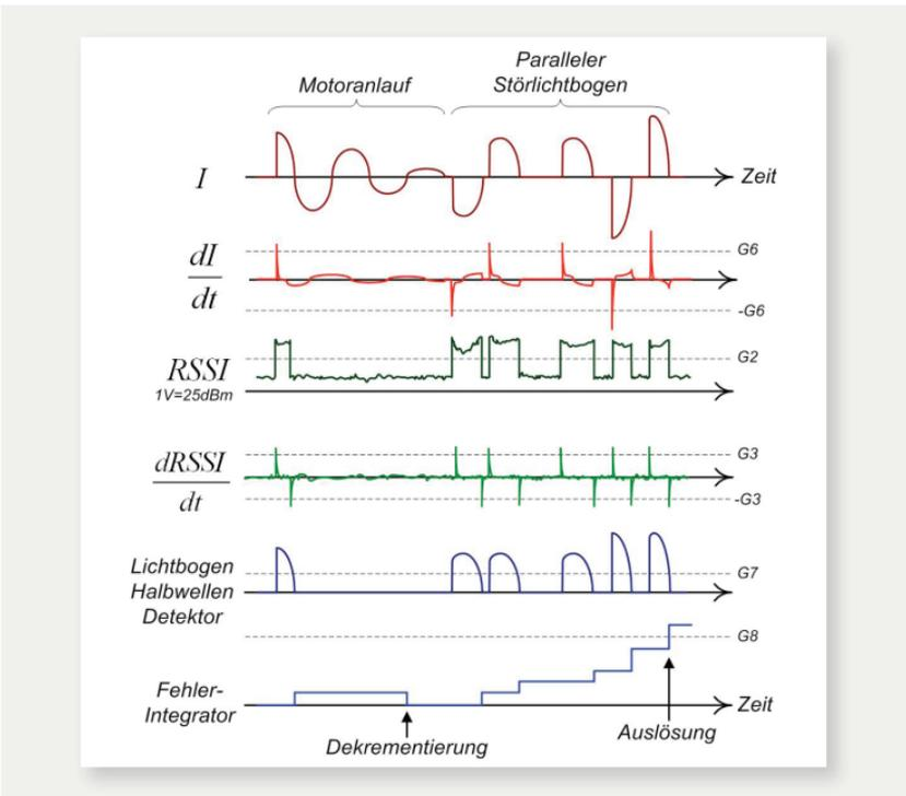
Bild 19: Signalverarbeitung zur Bewertung paralleler Fehlerlichtbögen
