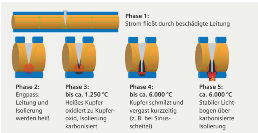
Bild 9: Brandentstehung durch serielle Lichtbögen
