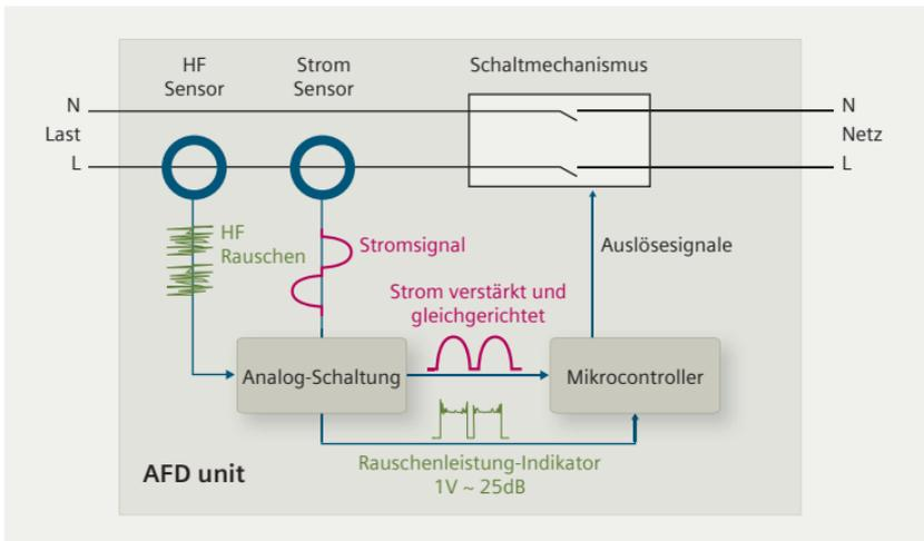
Bild 17: Prinzipieller Aufbau Brandschutzschalter 5SM6
