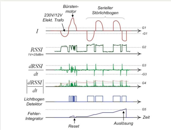
Bild 18: Signalverarbeitung zur Bewertung serieller Fehlerlichtbögen
