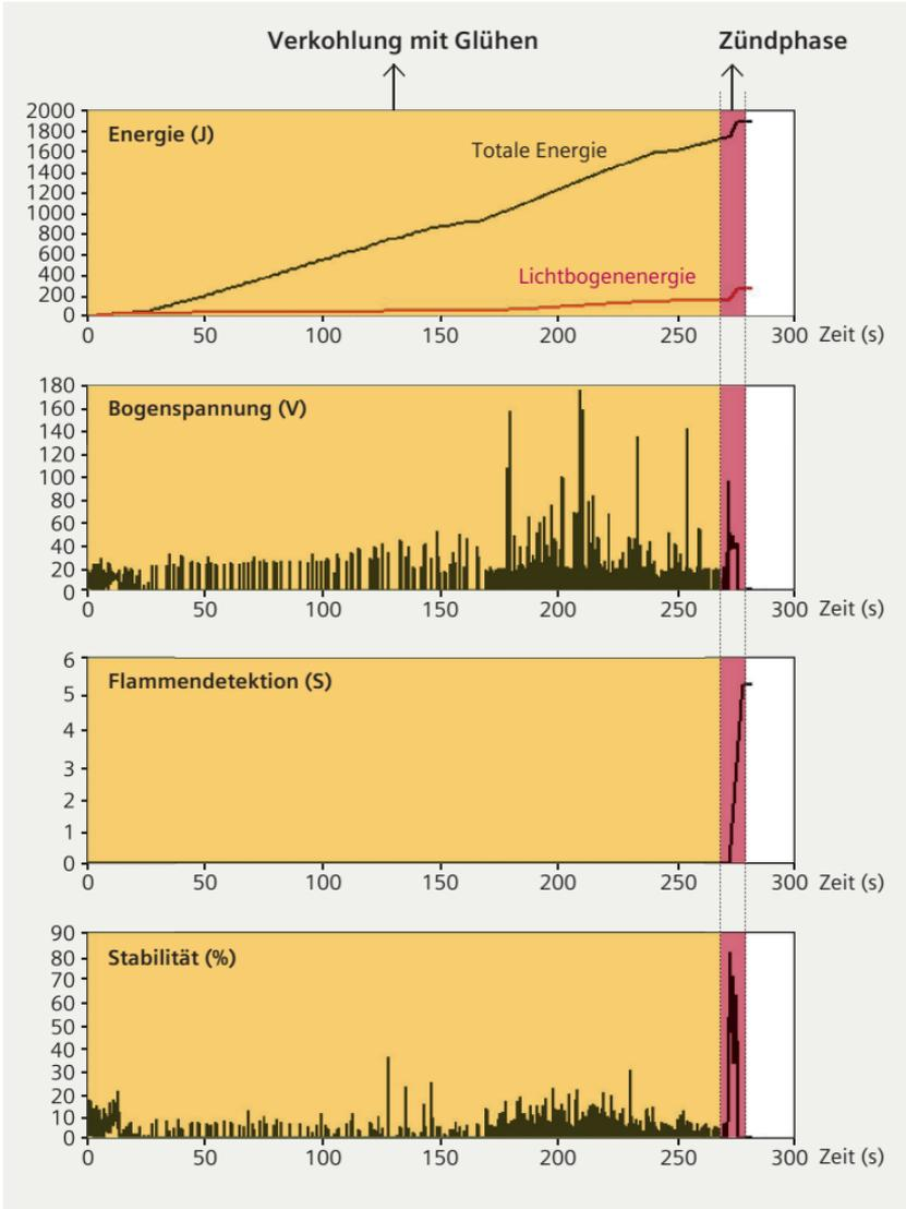
Bild 10: Entwicklung des Lichtbogens am Beispiel 2 A / 230 V
