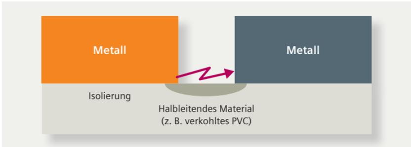
Bild 8: Lichtbogen über leitfähige Isolationsstrecke
