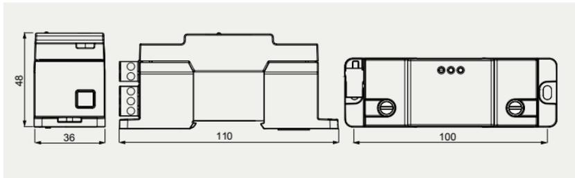
Bild A.1: Maßbilder des PV-Brandschutzschalters 5SM6 094-1
