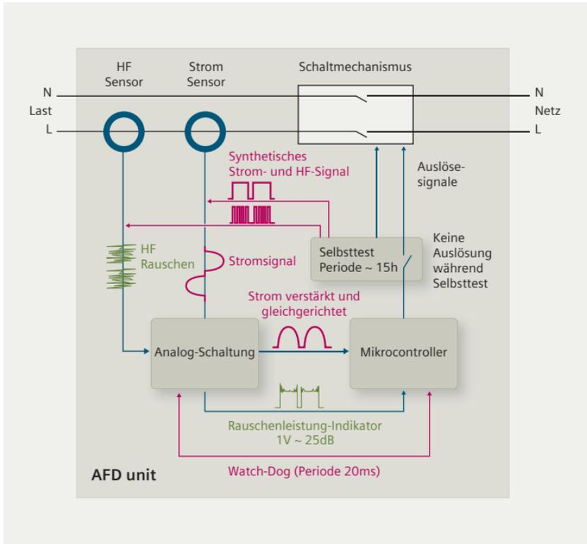
Bild 25: Schematische Darstellung des internen Selbsttests
