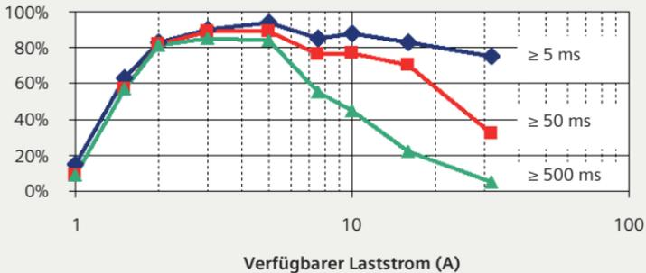
Bild 13: Auftritt der Flammen in Abhängigkeit des Laststroms
